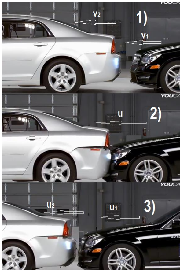
2 pav. Automobilių susidūrimo suspaudimo ir atsistatymo būvių iliustracija realiame automobilių smūgio teste [2]
