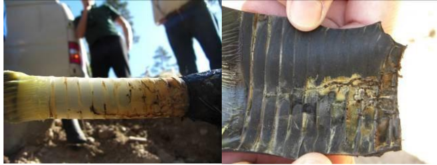
1.1.2.4 pav. Didžiuliai PD pėdsakai 2 metų senumo XLPE kabelio sandūroje esant 3000 m atstumui dėl prastos gamybos kokybės.
