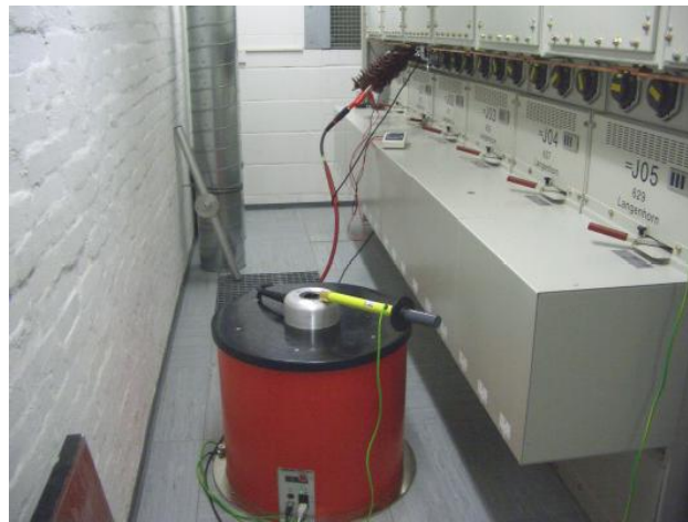
1.1.2.2 pav. OWTS M28 įrenginys: maks. įtampa 28 kV, svoris 55 kg, valdomas iš kompiuterio per WLAN arba internetą.
