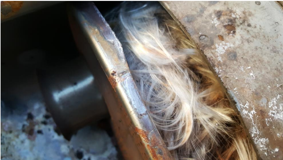
3.6 pav. Volvo V50 2.0d dujų išmetimo bakelio konstrukcija – stiklo pluoštas
