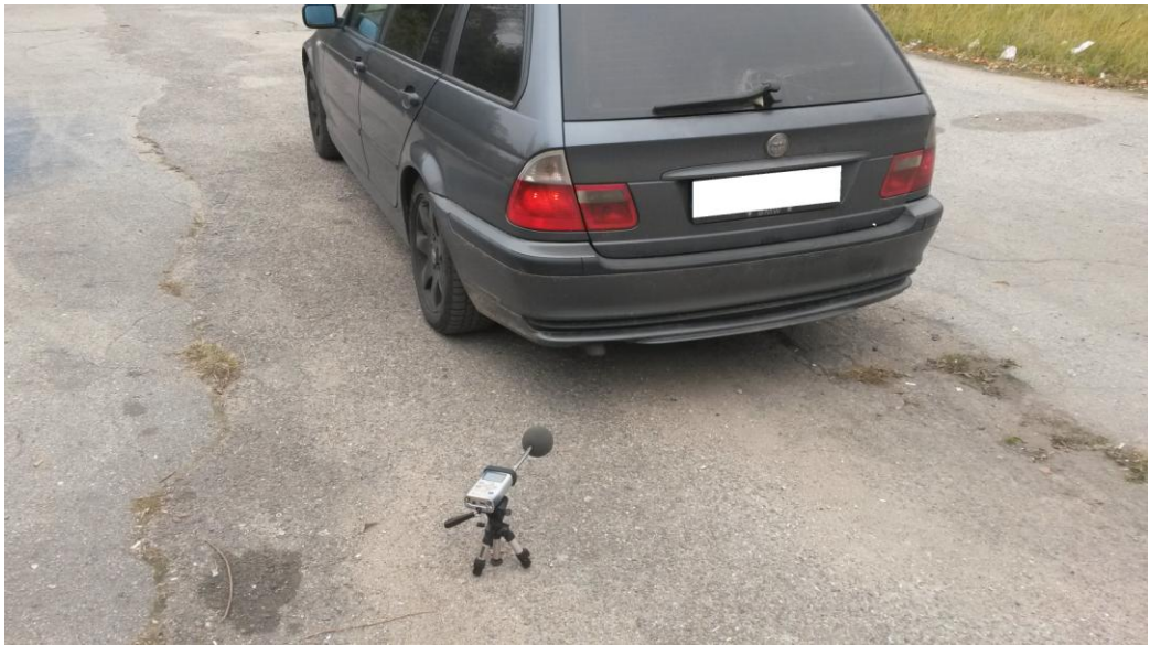
2.8 pav. Automobilio BMW 320d (be katalizatoriaus) triukšmo matavimas [25]
