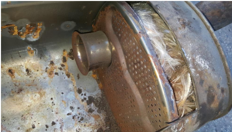
3.5 pav. Volvo V50 2.0d dujų išmetimo bakelio konstrukcija – pertvaros
