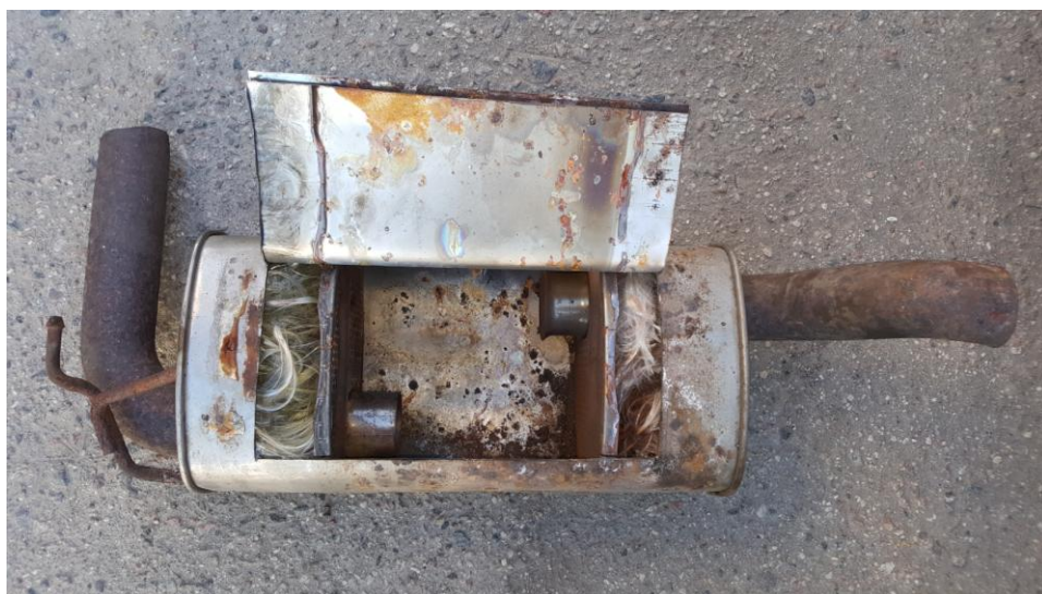
3.4 pav. Volvo V50 2.0d dujų išmetimo bakelis su pjūviu
