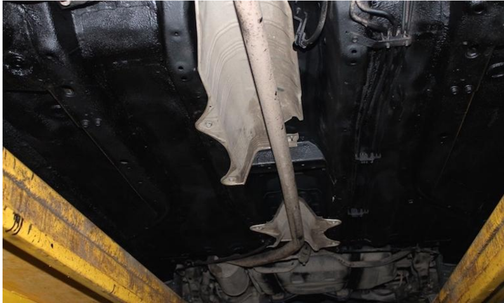
1.4 pav. Dugnas padengtas bitumo danga [10]
