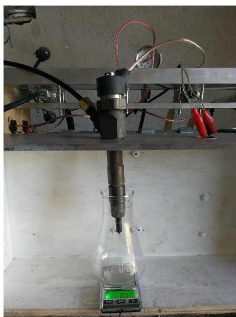
2.5 Pav. Kuro purkštuko debito matavimas naudojantis pagamintu stendu
