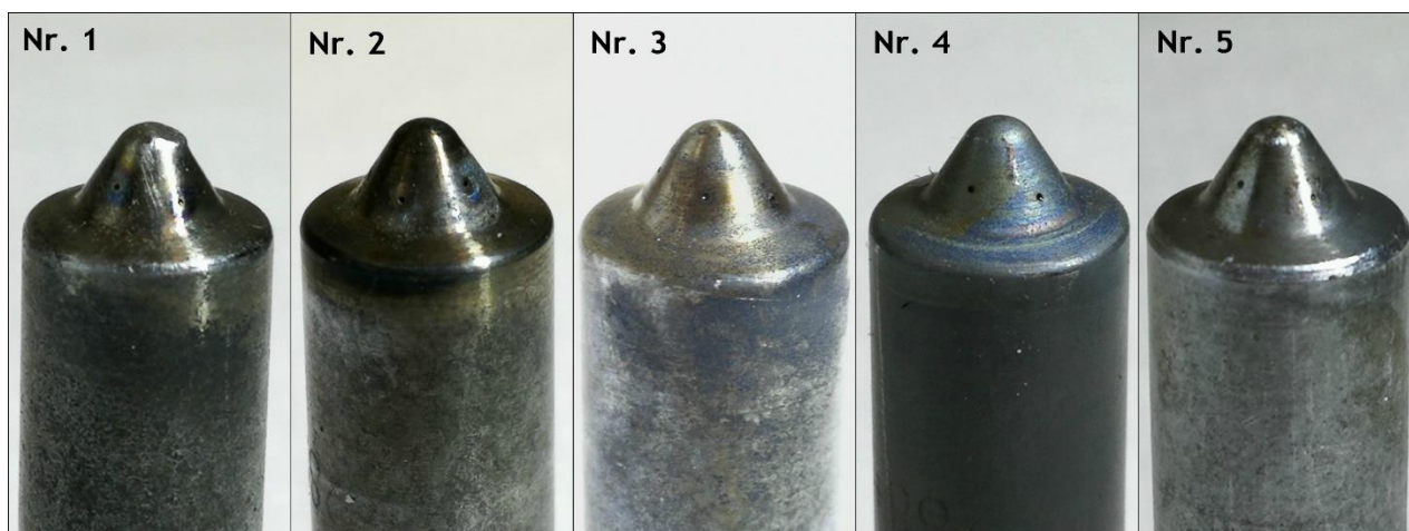
3.10 pav. Kuro purkštukų antgalių fotografijos po ultragarsinio plovimo
