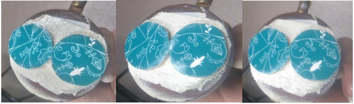
19 pav. Bandiniai, padengti soft touch laminavimo plėvele, po 5 min. trintie
