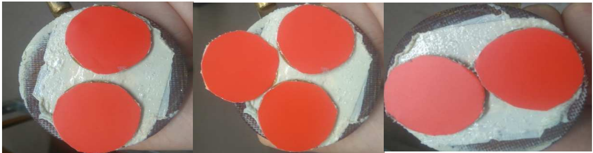
14 pav. Bandiniai, padengti matine atsparia laminavimo plėvele, po 10 min. trinties
