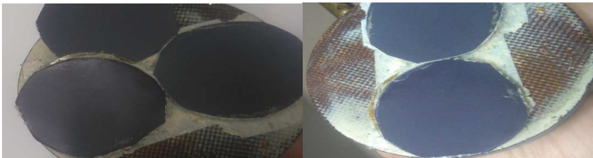
16 pav. Bandiniai, padengti matine laminavimo plėvele, po 10 min. trinties
