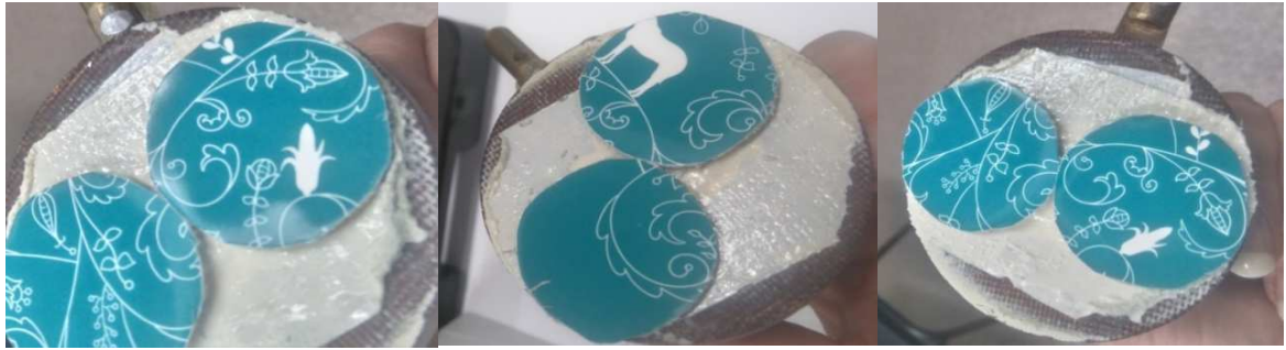
20 pav. Bandiniai, padengti soft touch laminavimo plėvele, po 10 min. trinties
