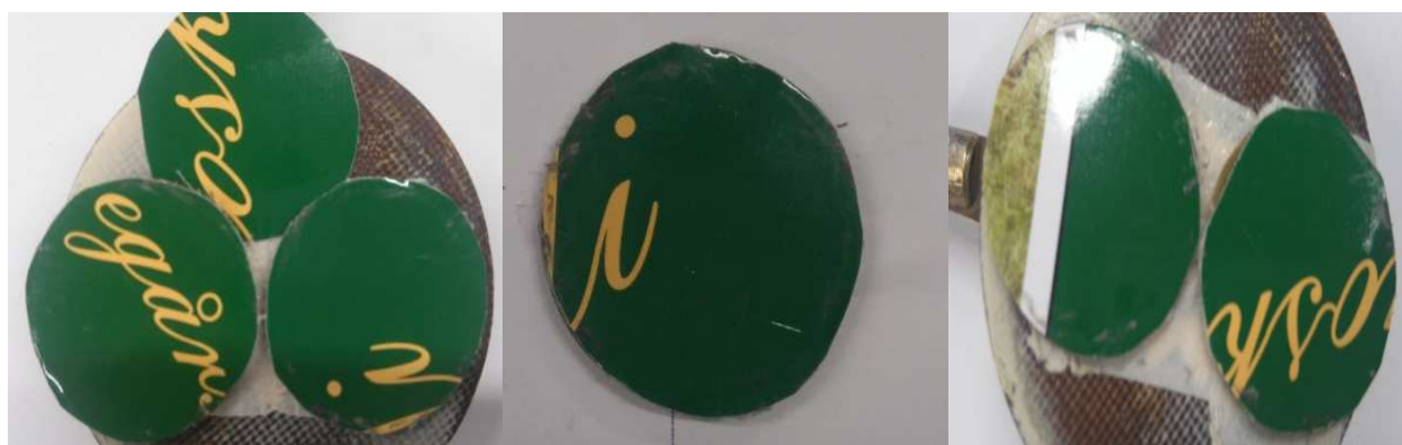
18 pav. Bandiniai, padengti blizgia laminavimo plėvele, po 10 min. trinties
