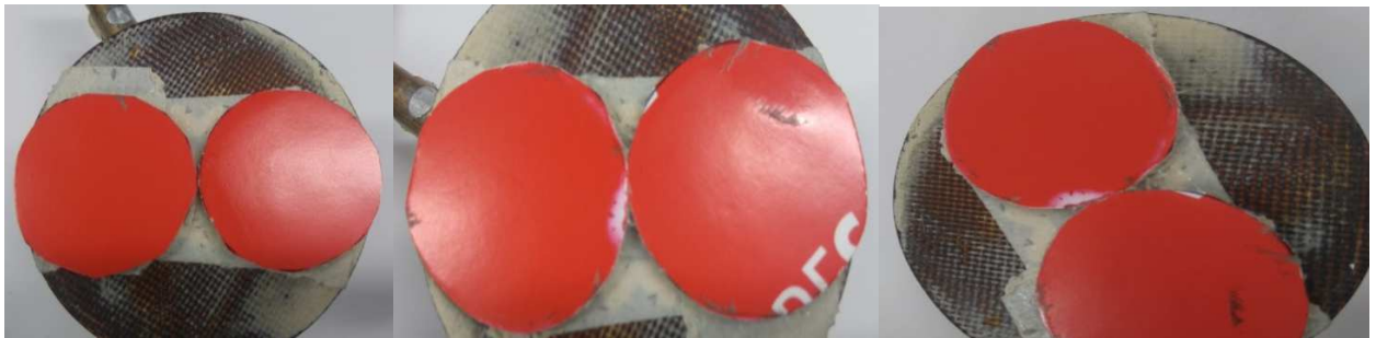
21 pav. Bandiniai, padengti apsauginiu laku, po 5 min. trinties
