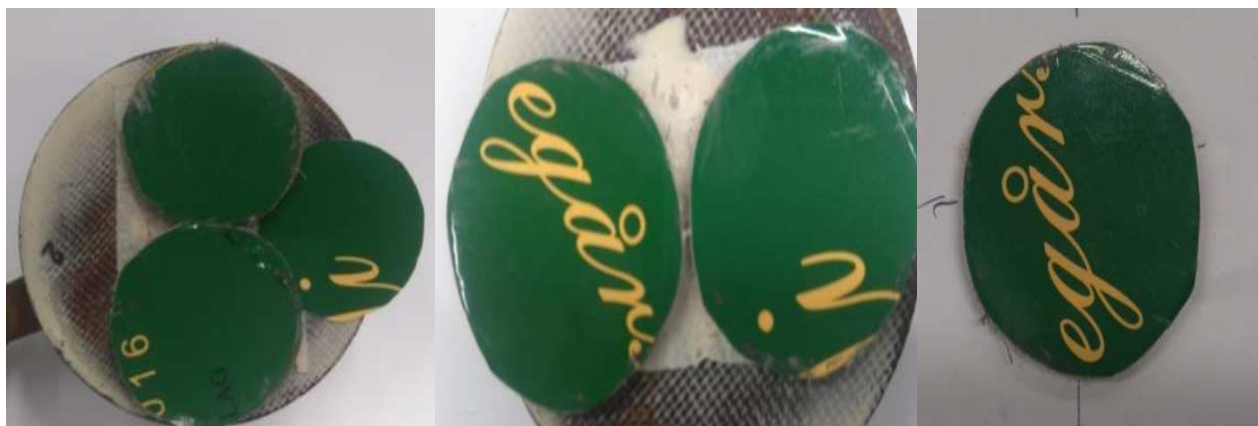
17 pav. Bandiniai, padengti blizgia laminavimo plėvele, po 5 min. trinties
