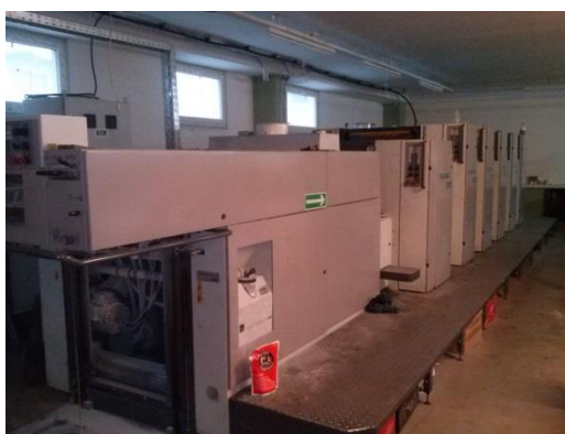
25 pav. Penkių spalvų spaudos mašina MAN Roland 305 P+LV
