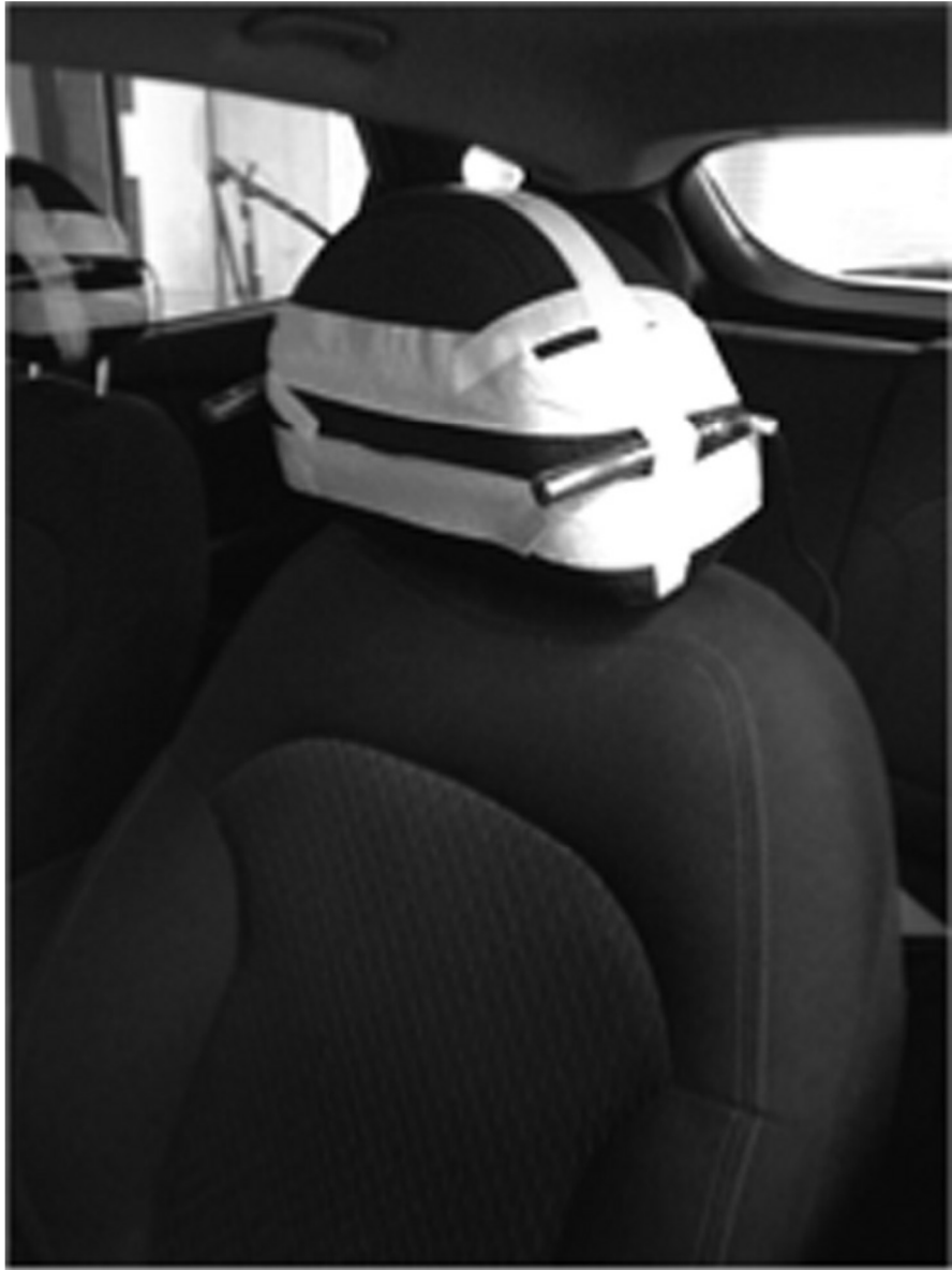
3 pav. Mikrofonų įtvirtinimas tyrimo metu [6]
