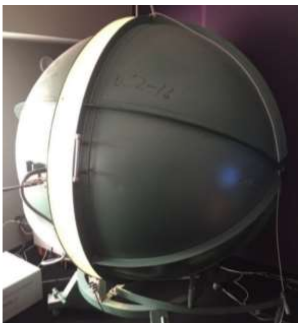
7.4.1 pav. Tyrime naudota fotometrinių integravimo sfera
