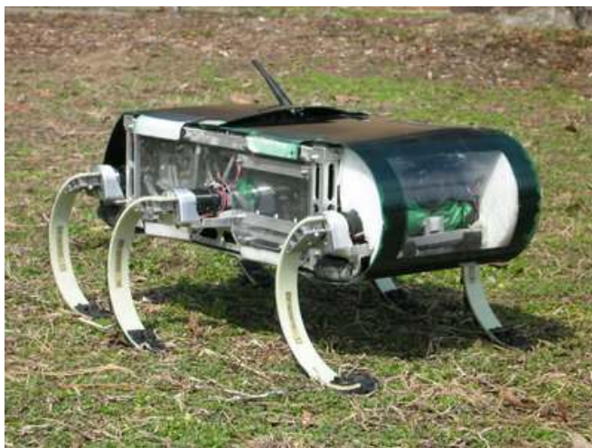
10 pav. RHex tipo robotas [6]
