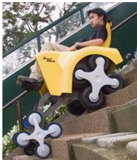
2 pav. Neįgaliojo vežimėlis su žvaigždinių ratų moduliais [2]
