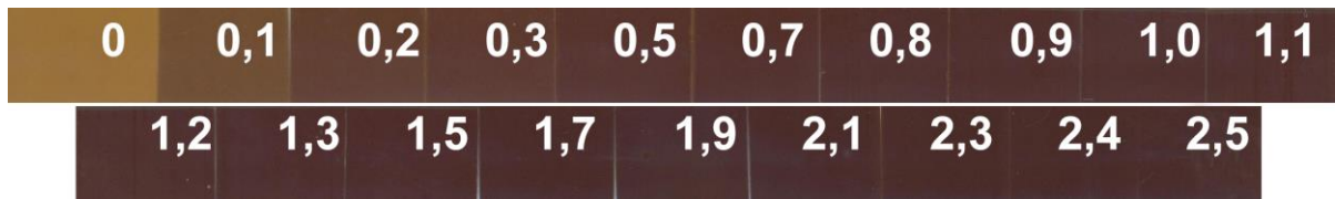
3.3 pav. Kalibracinė GafChromic filmų, apšvitintų skirtingomis dozėmis, juostelė
