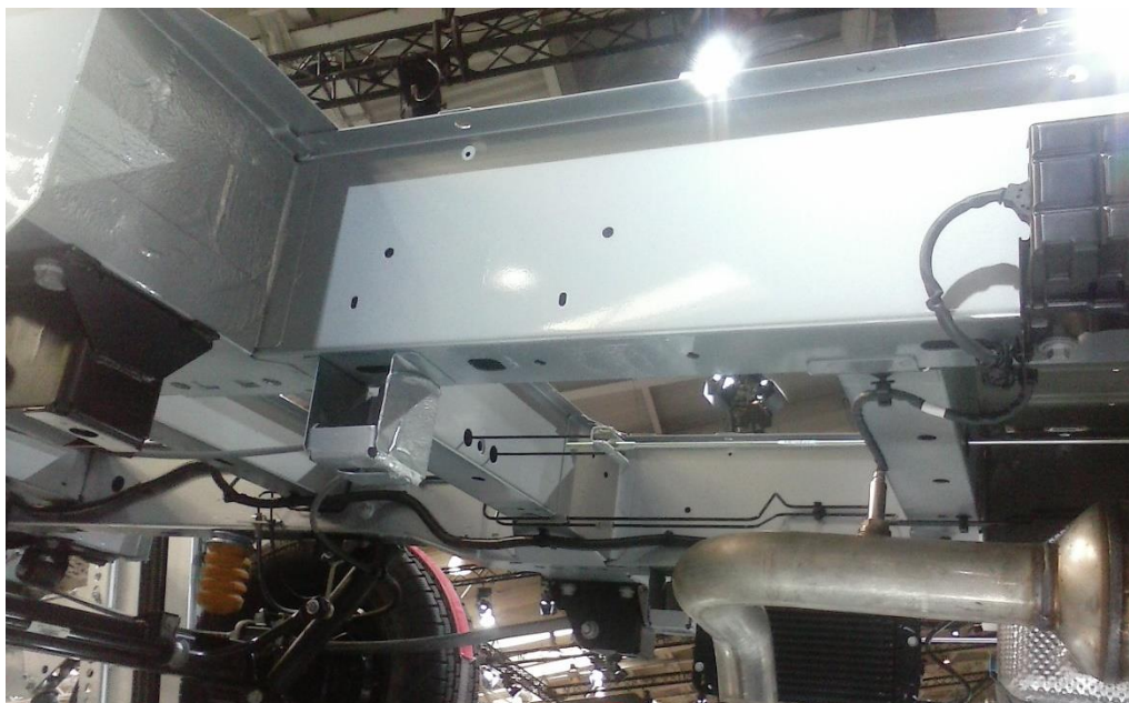
1 pav. Lengvojo sunkvežimio Renault Master rėmas, turintis 2mm sienelės storį
