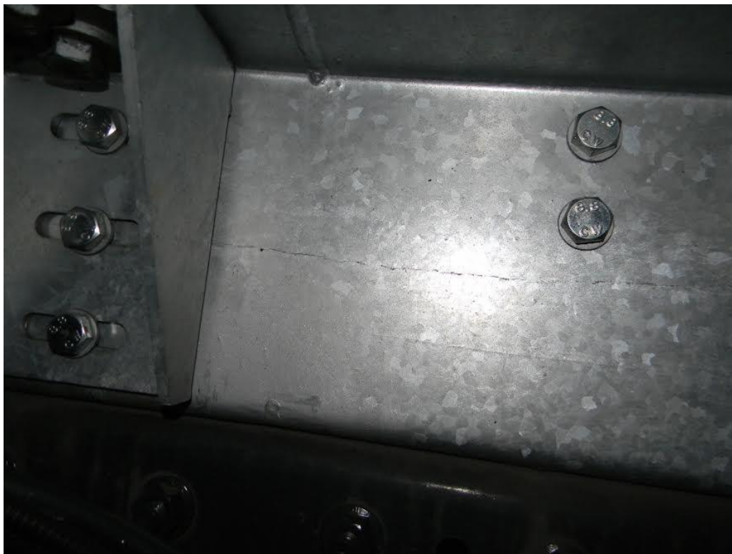
2 pav. Trūkusi porėmio išilginė sija
