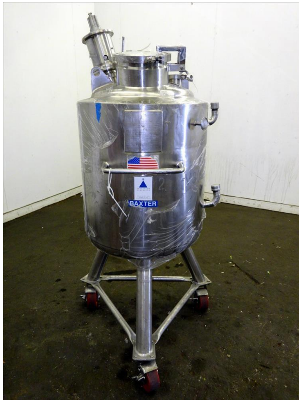
4.2. „Precision Stainless Inc“ nerūdijančio plieno reaktorius [5].
