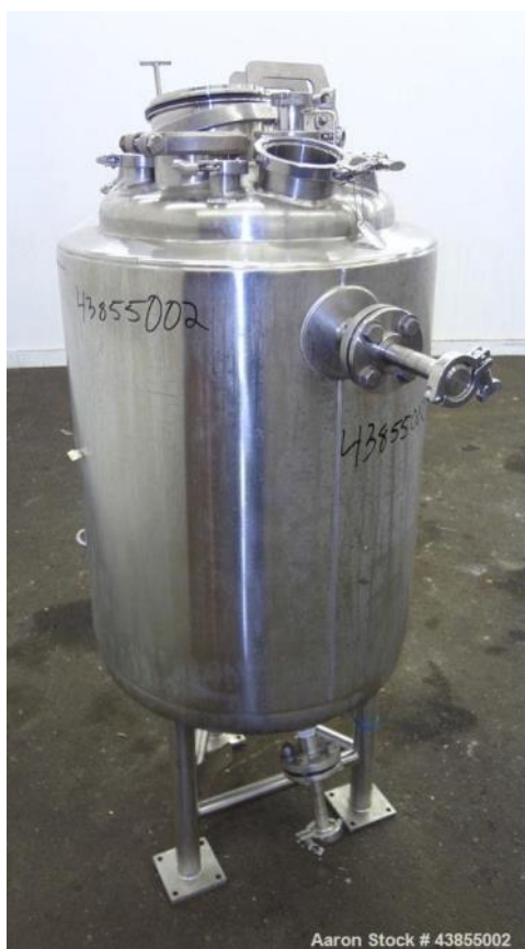
4.3 pav. „Pure-Flo“ nerūdijančio plieno reaktorius [8].
