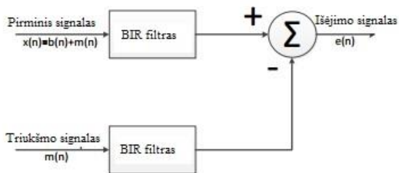
3.1 pav. Filtro BIR ir signalo dažninės analizės kombinavimo realizavimas Matlab aplinkoje, kur b(n) – kvėpavimo signalas, m(n) – širdies ar kito aukšto dažnio triukšmas, e(n) – filtruotas signalas [14]
