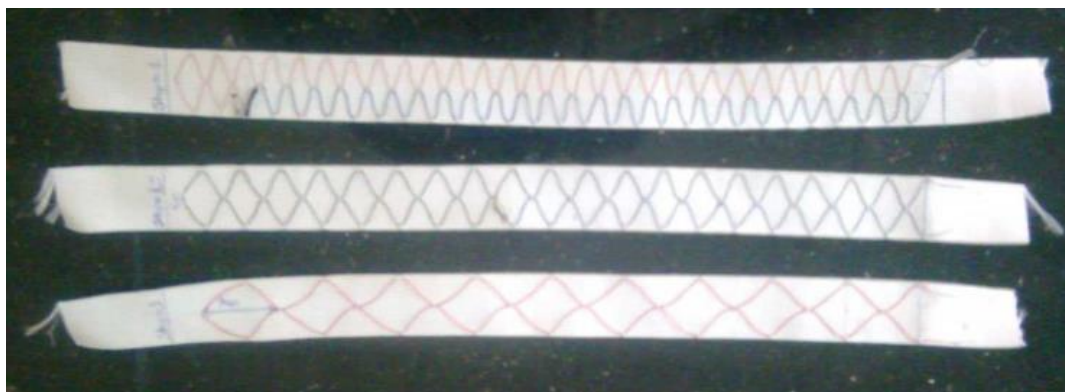
1.3.2 pav. Diržas su zigzagais išdėliotais laidais, skirtas induktyvinei pletizmografijos monitoringui [7]
