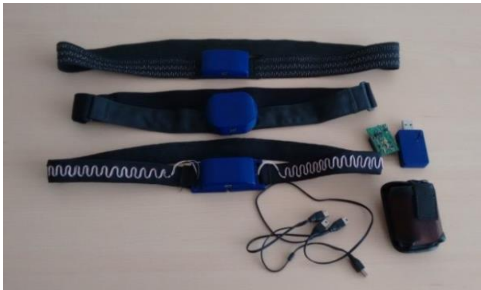
5.1 pav. EKG (vidurinis) ir induktyvinės pletizmografijos jutiklių signalų, širdies darbo dažnio ir kvėpavimo dažnio monitoringas realiu laiku. Belaidis nelicenzijuoto 2,4 GHz dažnio ryšys (ZigBee duomenų perdavimo protokolas).
