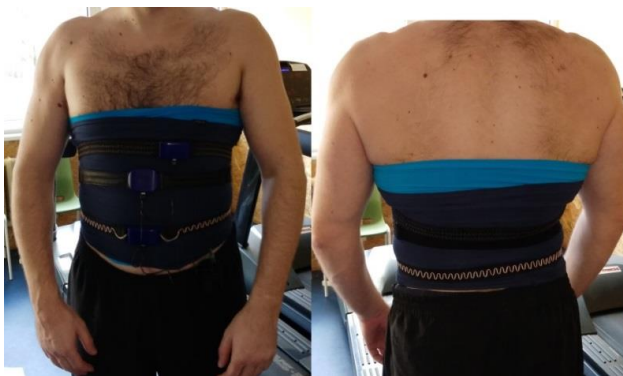
5.2.2 pav. 3 bandymas. Talijos suspaudimas standžia elastine juosta
