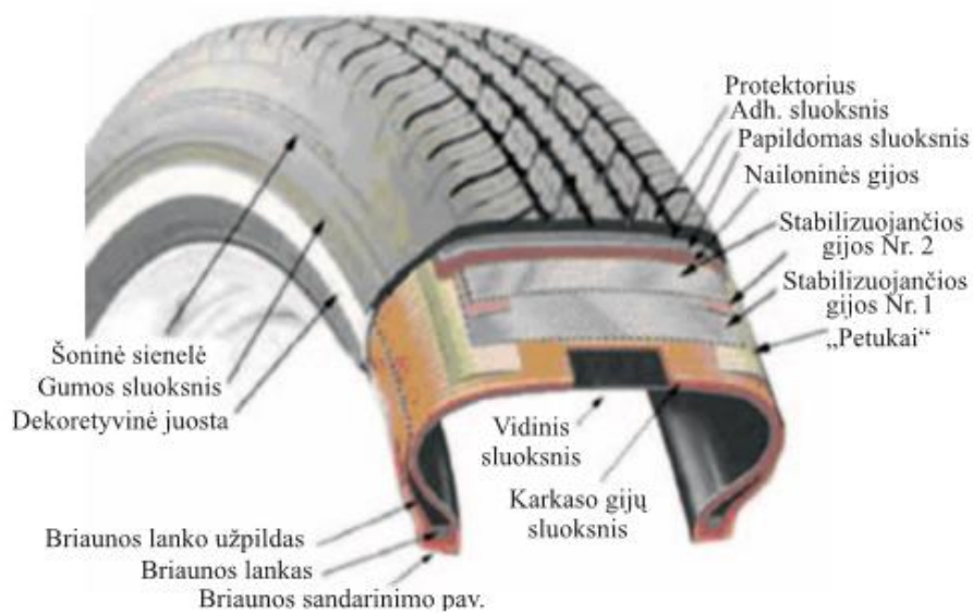
5 pav. Radialinės padangos konstrukcija [4]
