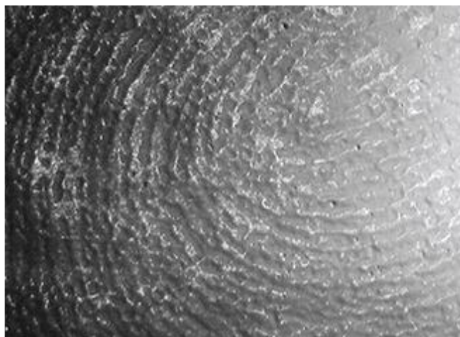
1.9 pav. Paviršiaus netolygumai, susidarantys dėl nedrėkinimo [4]
