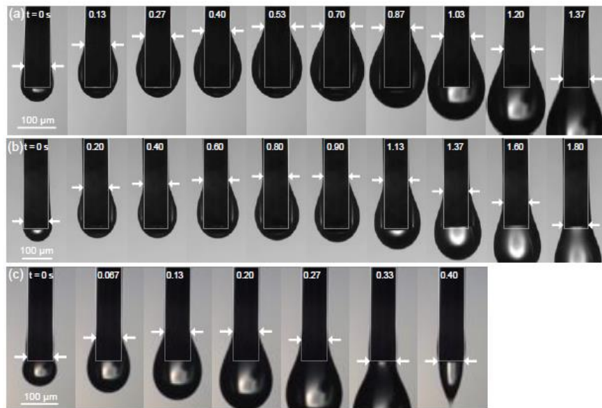
1.4 pav. Lašo formavimasis naudojant skirtingų tipų kapiliarinius antgalius ir skysčio tėkmės srautą: a) R=0,292 mm, 50 ml/val.; b) R=0,406 mm, 50 ml/val.; c) R=0,292 mm, 200 ml/val. [2]
