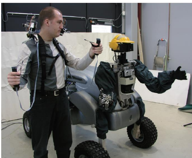
10 pav. Operatorius su integruotu nuotolinio valdymo įtaisais
