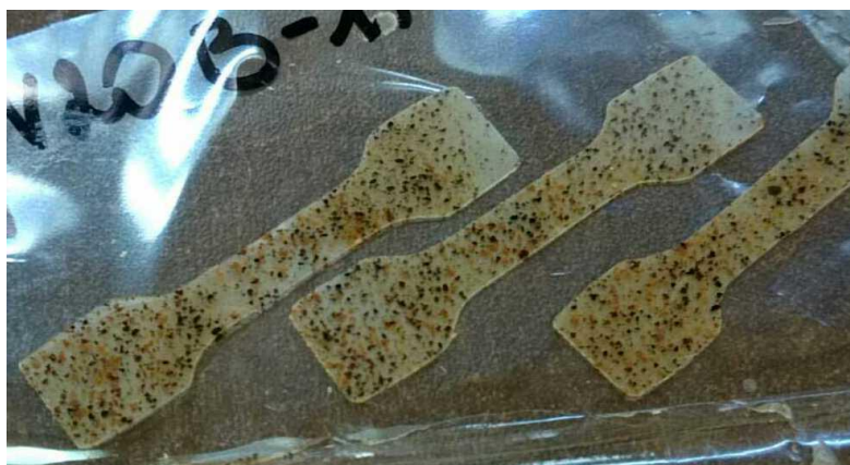
3.17 pav. 20 % grūdų išvalų ir piktžolių mišinio kompozito plėvelių kaulo formos mėginiai tempimo bandymui
