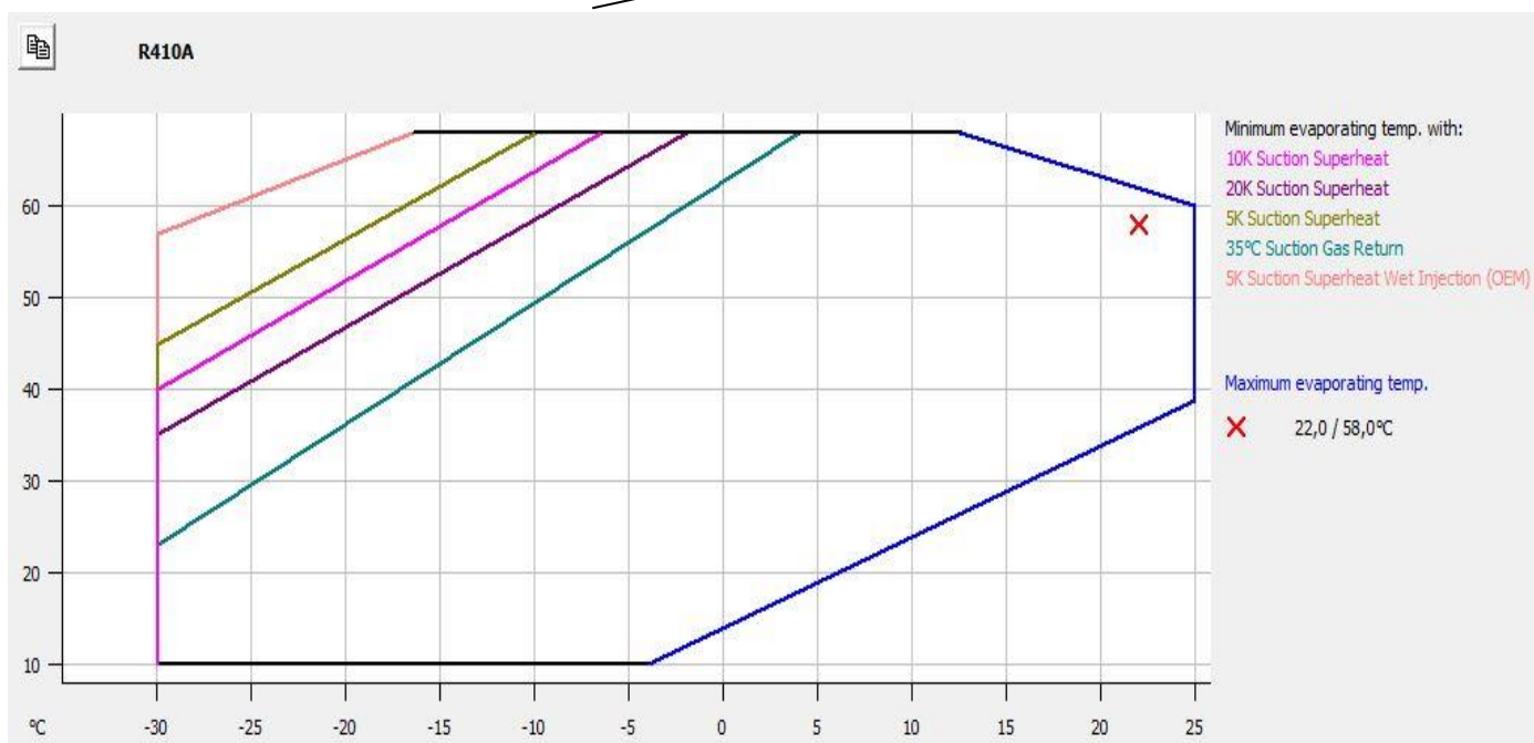
6 pav. kompresoriaus veikimo grafikas
