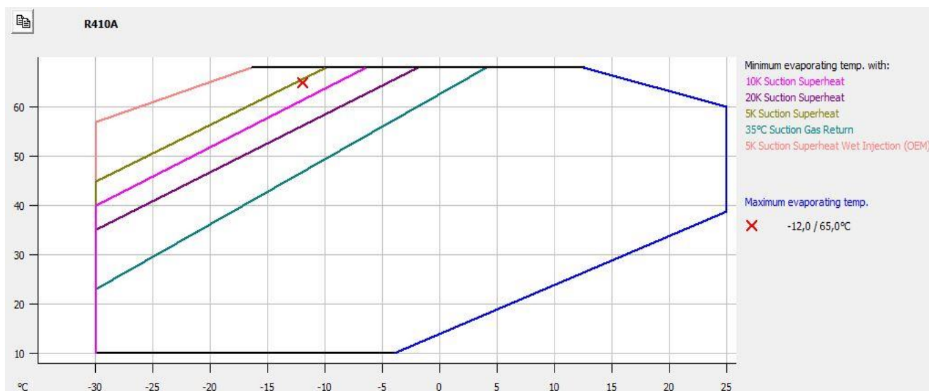
10 pav. kompresoriaus veikimo grafikas
