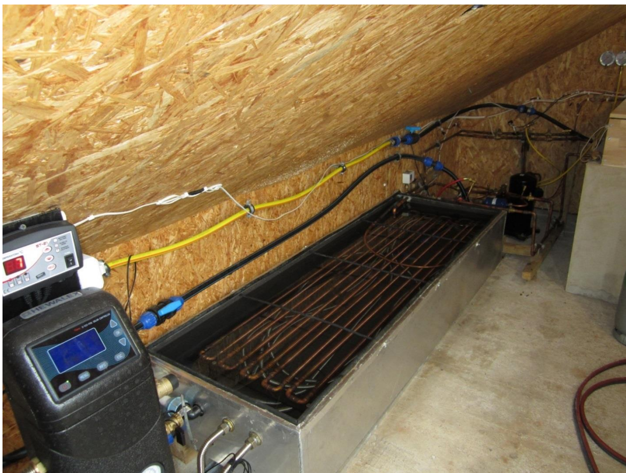
4.19 pav. Surinktas garintuvas ir patalpintas akumuliacinėje talpoje.
