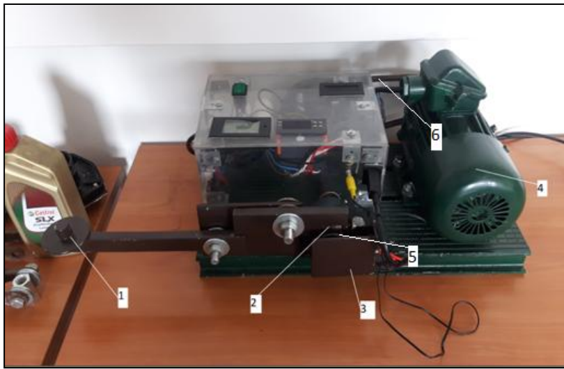
2.4. pav. Timken bandymų stendas, 1 – svirtis skirta apkrovai, 2 – bandinys, 3 – alyvos vonelė, 4 – elektros variklis, 5 – velenas, 6 – diržinė pavara
