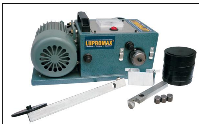
1.5. pav. Timken bandymų stendas [16]
