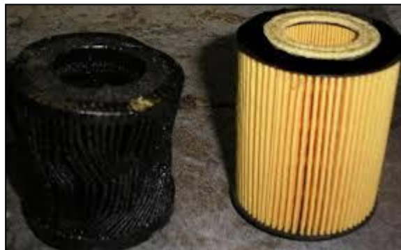
1.2. pav. Skirtumas, tarp naujo filtro ir visiškai užkimšto filtro [13]
