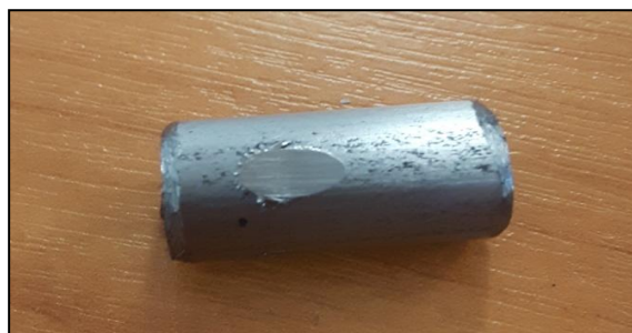
2.5. pav. Bandinys, po 7 minučių dilinimo
