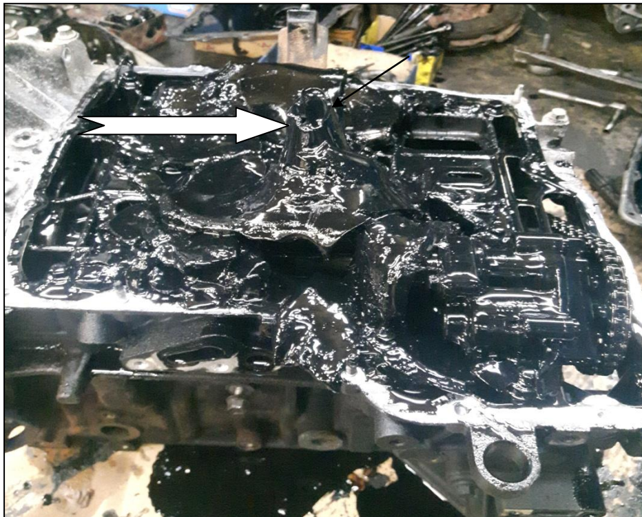
1.7. pav. Stipriai užteršta alyva, užkemša alyvos paėmimo kanalus, rodykle pažymėtas alyvos paėmimo kalanas
