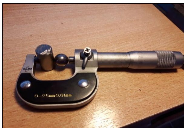
2.6. pav. Atliekamas bandinio išdilimo matavimas
