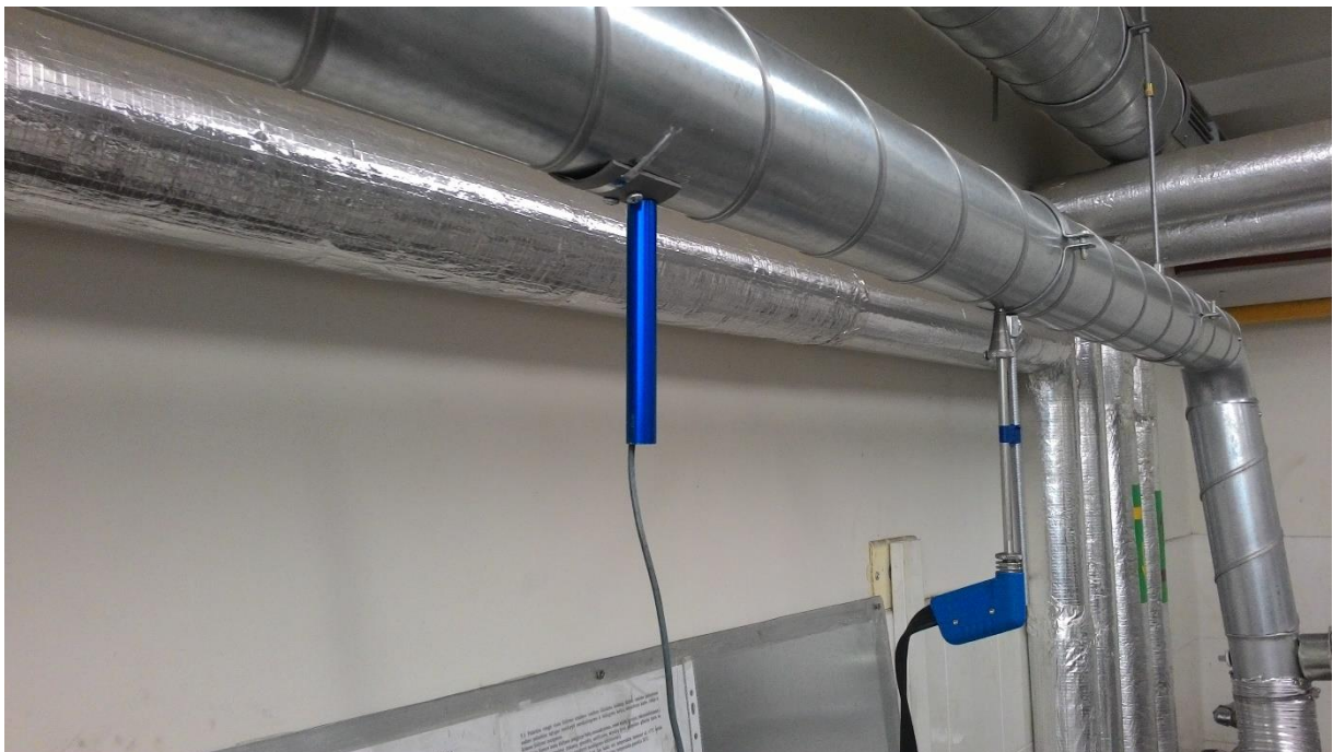
2.3.2 pav. REC dūmų sudėties bei greičio matavimas.
