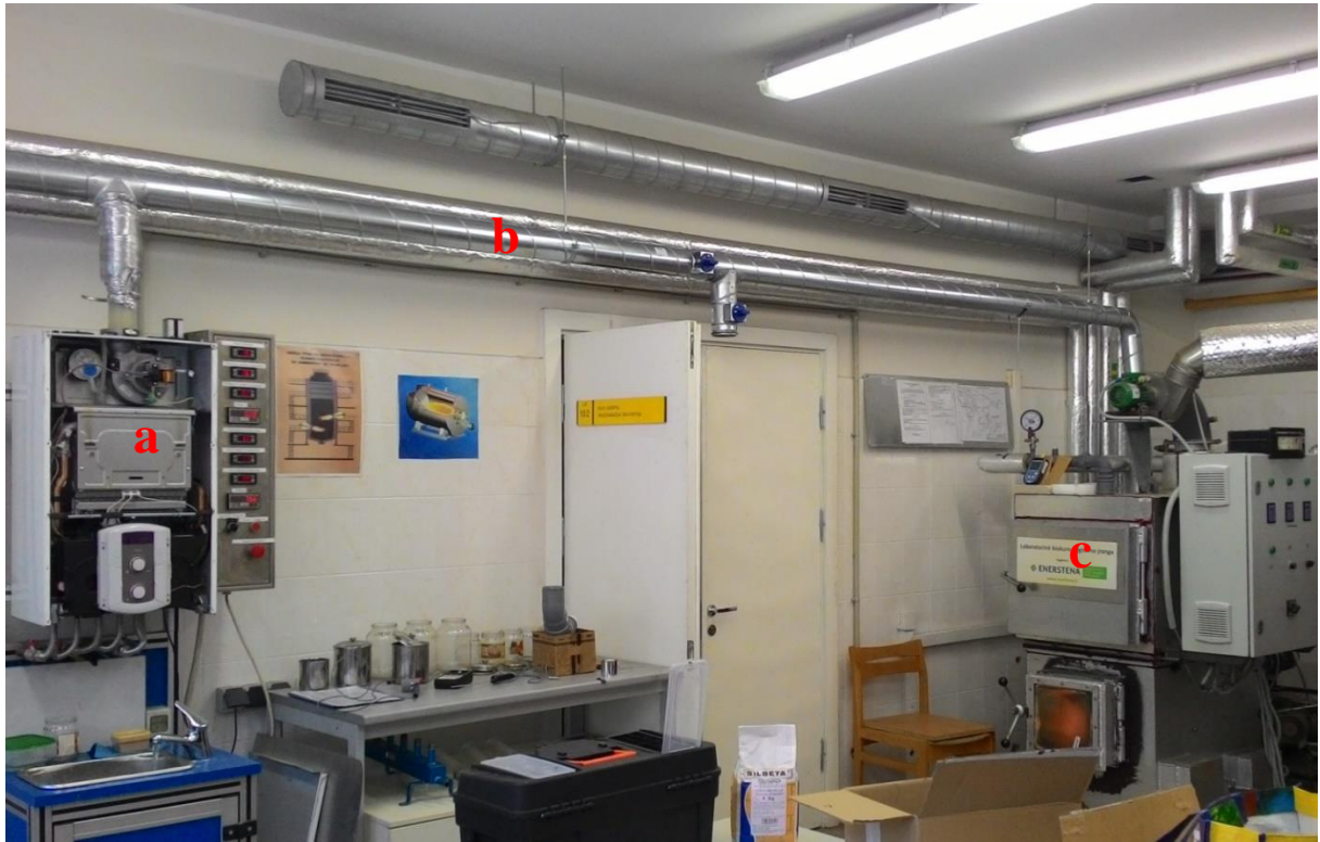
2.3.1 pav. a) buitinis dujinis katilas; b) REC dūmų kontūras; c) degimo stendas.
