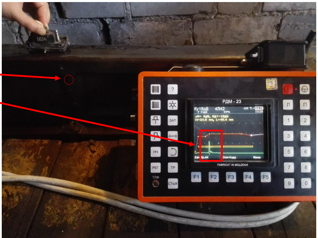
3.1.3.10. pav. Dirbtinio defekto aptikimas bėgio kakliuke defektoskopu RDM-23
