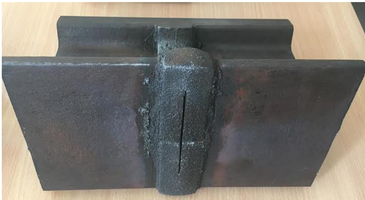
3.3.2pav. UIC60 bėgis su įpjova termitinės sandūros pade
