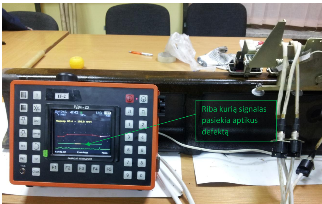
3.1.2.1 pav. Bandymas aptikti defektą su defektoskopu RDM-23
