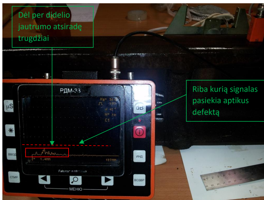
3.1.1.7.pav. Bandymas aptikti defektą su 45° ieškikliu su padidintu jautrumu iki 30 dB
