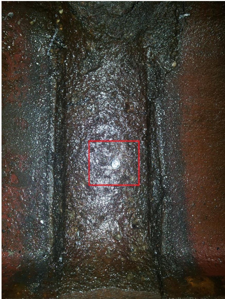
3.1.3 pav. Dirbtinis defektas termitinės sandūros zonoje.
