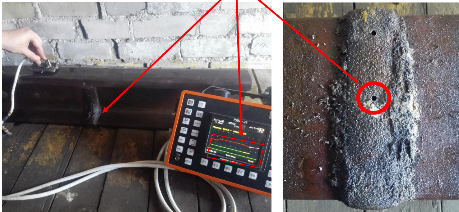
3.1.3.7. pav. Dirbtinio defekto pade tikrinimas išsistinės kontrolės ieškikliais.
