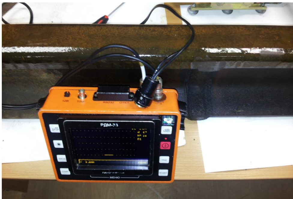
3.1.1.2. Defektoskopas RDM-33 su 0° įvedimo kampo rankiniu AS ieškikliu
