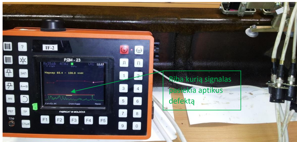
3.1.2.3.pav. Trukdžiai atsiradę padidinus jautrumą iki 25 dB
