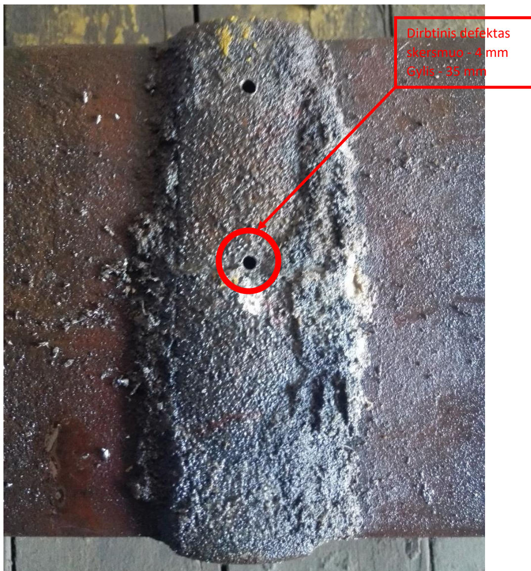
3.1.3.6 Pav. Dirbtinis defektas pade
