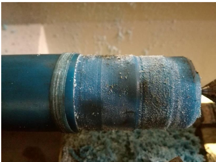
2.8 pav. Skirtingu režimu tekintas mėlynas poliuretanas
