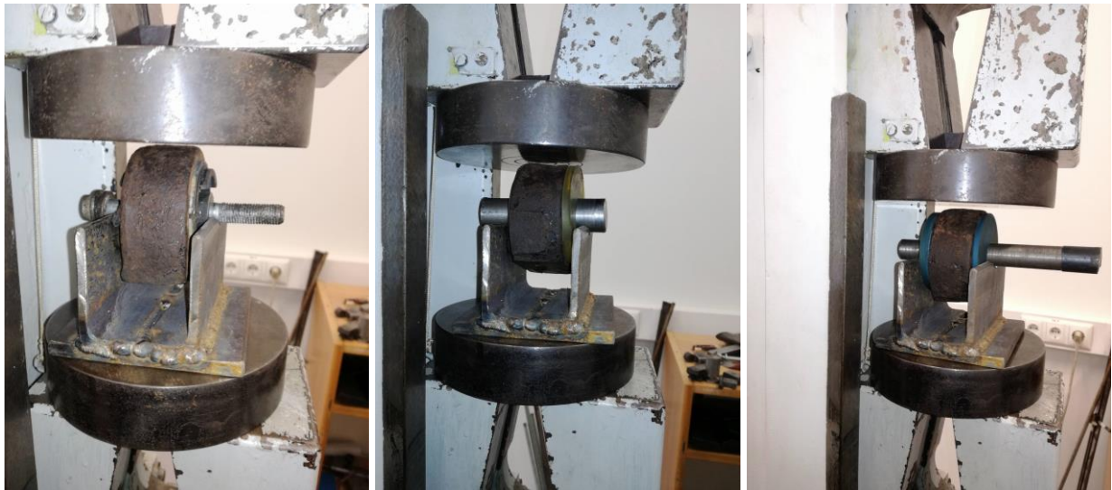
3.21 pav. Ketvirtos įvorės bandymai: a – standartinė įvorė; b – geltono poliuretano įvorė; c – mėlyno poliuretano įvorė
