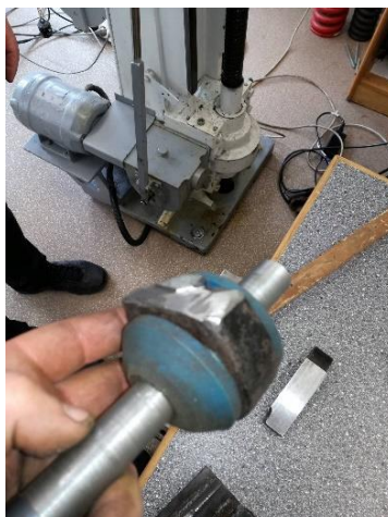
2.9 pav. Bandymui paruošta poliuretano įvorė
