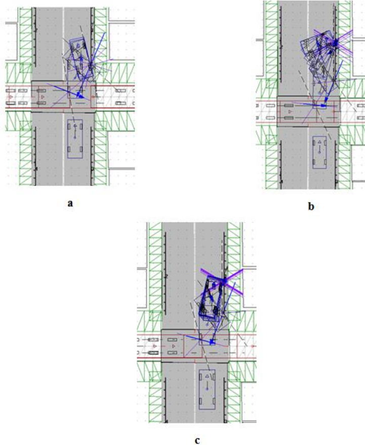
24 pav. Susidūrimų penktoje zonoje schemas, kai automotrisės greitis ir automobilio greitis yra 60 km/h a – „BMW“, b – „VW“, c – „Mercedes – Benz“
