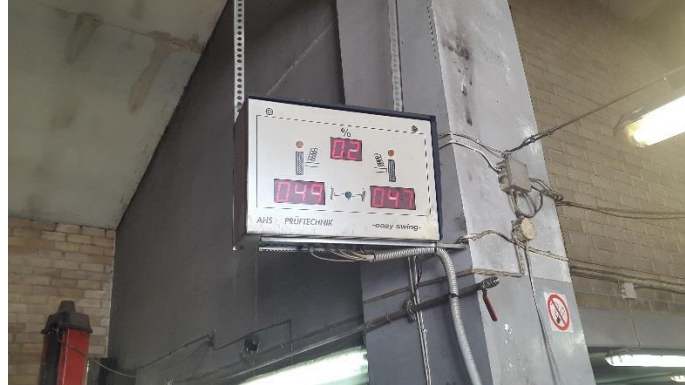
29 pav. Priekinės ašies virpesių slopintuvų būklės nustatymas
