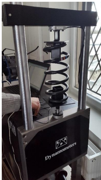
7 pav. Matavimo stendas su bandomąja spyruokle
