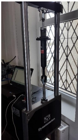
8 pav. Matavimo stendas su paruoštu virpesių slopintuvu
