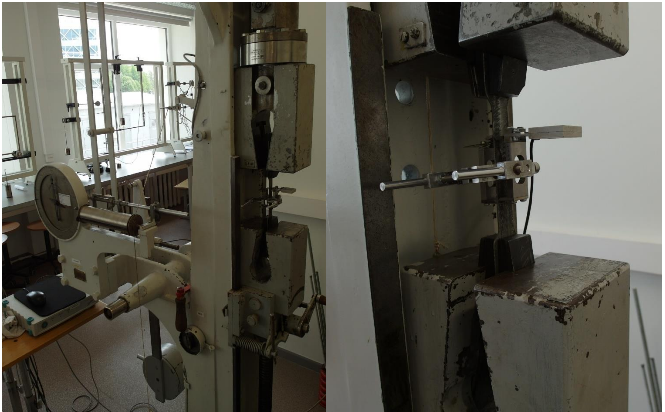
2.5 pav. Universali tempimo bandinių mašina
