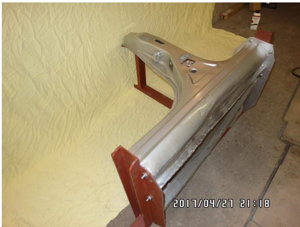
2.10 pav. Slenksčio konstrukcija įtvirtinta rėme
