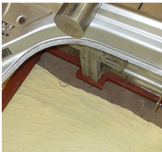
2.11 pav. Smūgio vieta grindų stiprintuvo vietoje
