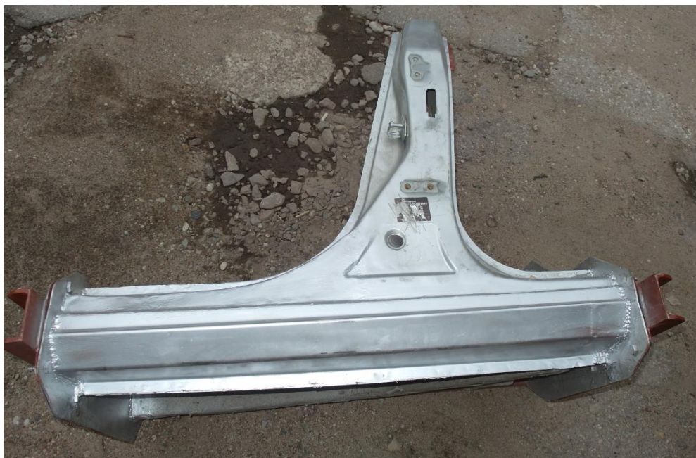
2. pav. Slenksčio išorinė dalis keista nauja
