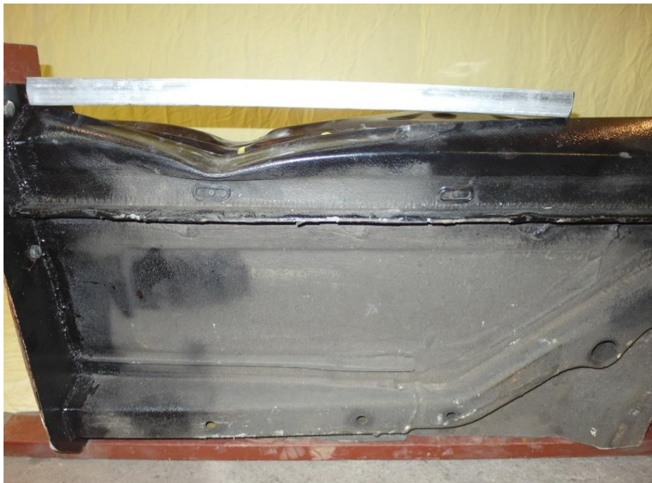
2.9 pav. Pažeista slenksčio konstrukcija
