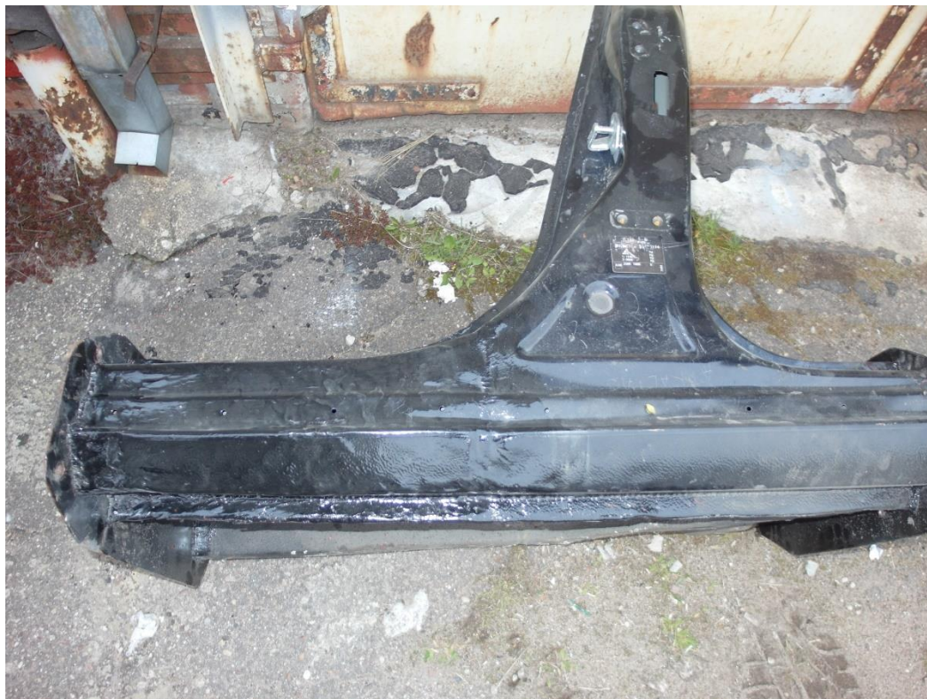
2.9pav. Slenksčio dalis keičiama iš kito automobilio
