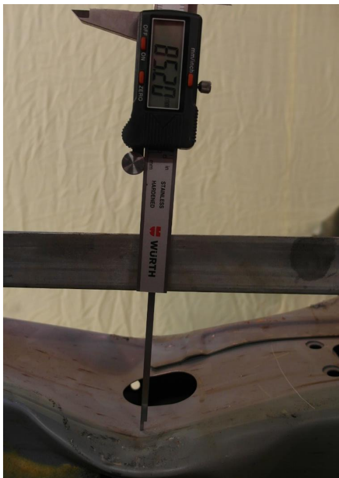
2.14 pav. Kontrolinio bandinio išliekamosios deformacijos
