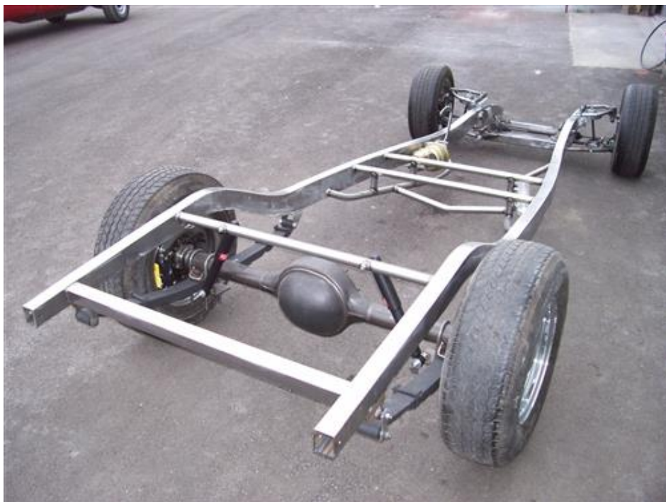
1.2 pav. Automobilio laikantysis rėmas [13]
