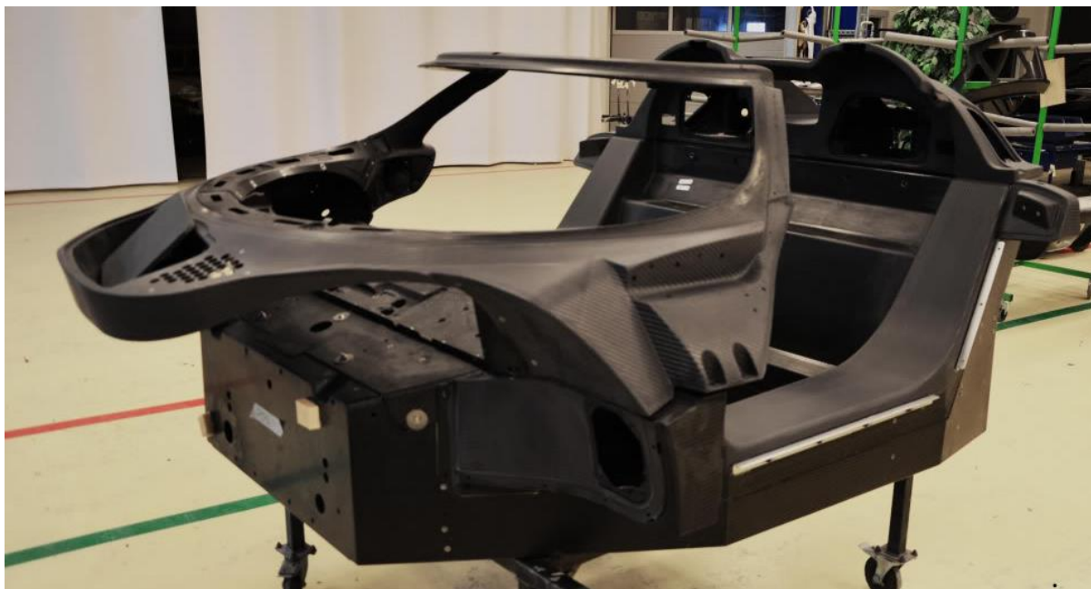
1.3 pav. „Koenigsegg“ automobilio anglies pluošto kėbulas [14]
