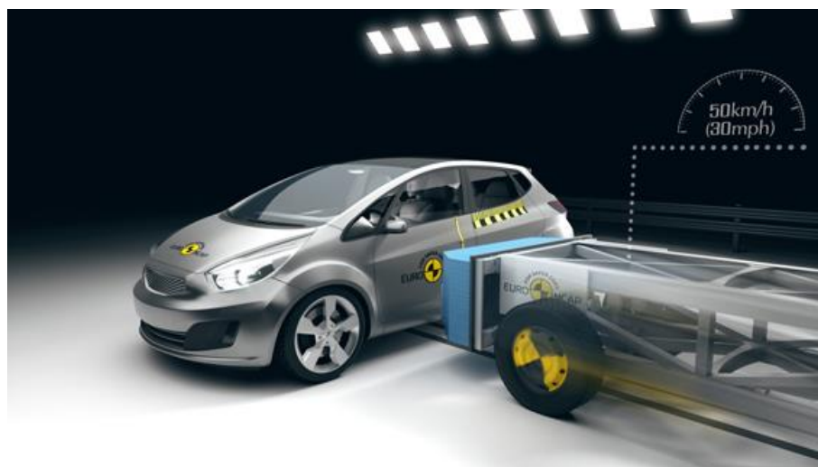
1.12 pav. Šoninio smūgio testas su deformuojamu vežimėliu [23]
