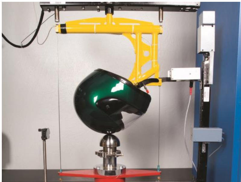
1.3.pav. Motociklo šalmo smūgio sugėrimo testas
