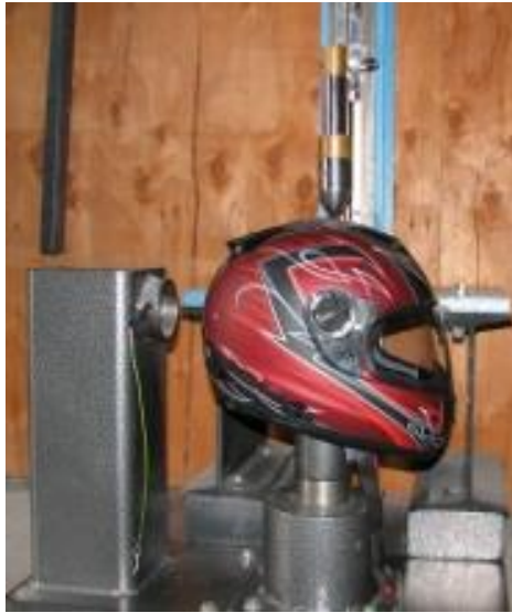
1.1.pav. Motociklo šalmu prasiskverbimo testas
