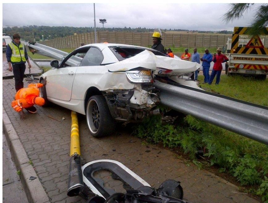
3.5. pav. Avarija į atitvaro pradžia esančią virš žemės.
