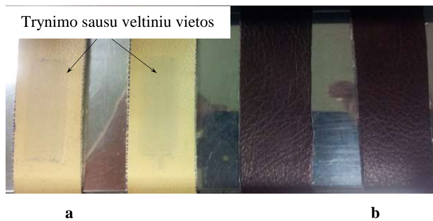
4.27 pav. Dirbtinės odos „Dakota“ ir „Montana“ ilgalaikio ciklinio slankiojamojo tyrimo rezultatai; a – dirbtinė oda „Montana“ ; b – dirbtinė oda „Dakota“
