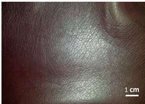
4.15 pav. Dakota ėminys iš baldų; a – odos pavyzdys iš baldų; b – defektuotos odos paviršius po mikroskopo tyrimo.
