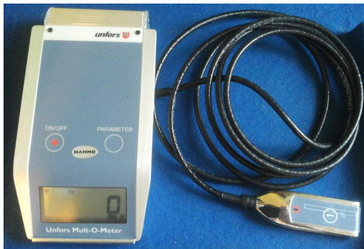
15 pav. Unifors Mult-O-Meter detektorius
