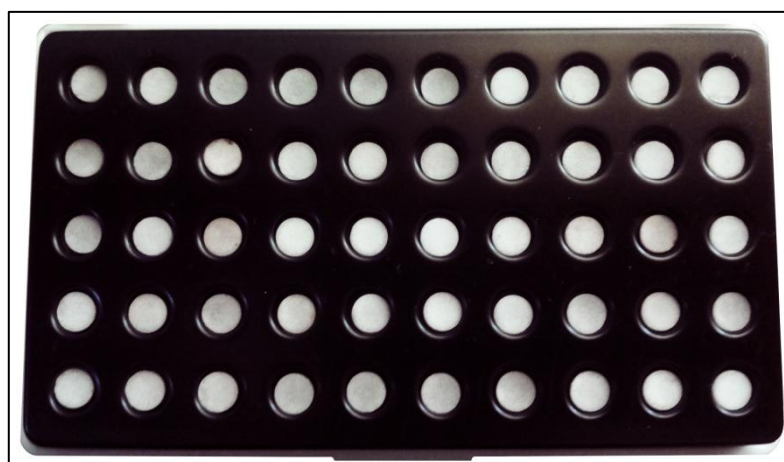
19 pav. Termoluminescencinių dozimetrų dėklas (50 vnt.)
