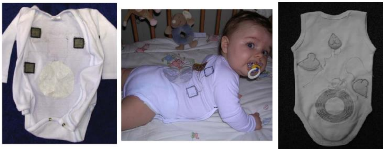
Pav. 1.9 Belaidė monitoringo sistema [12,13]
