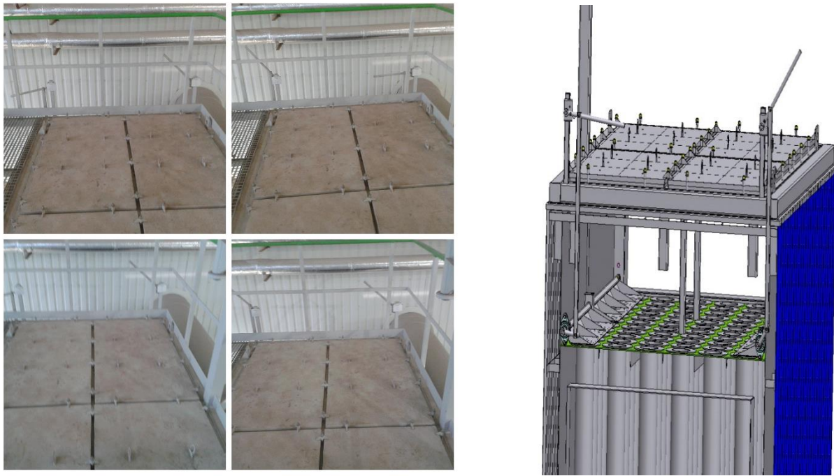
1.7 pav. Multiciklono reguliuojančių sklendžių pozicija
