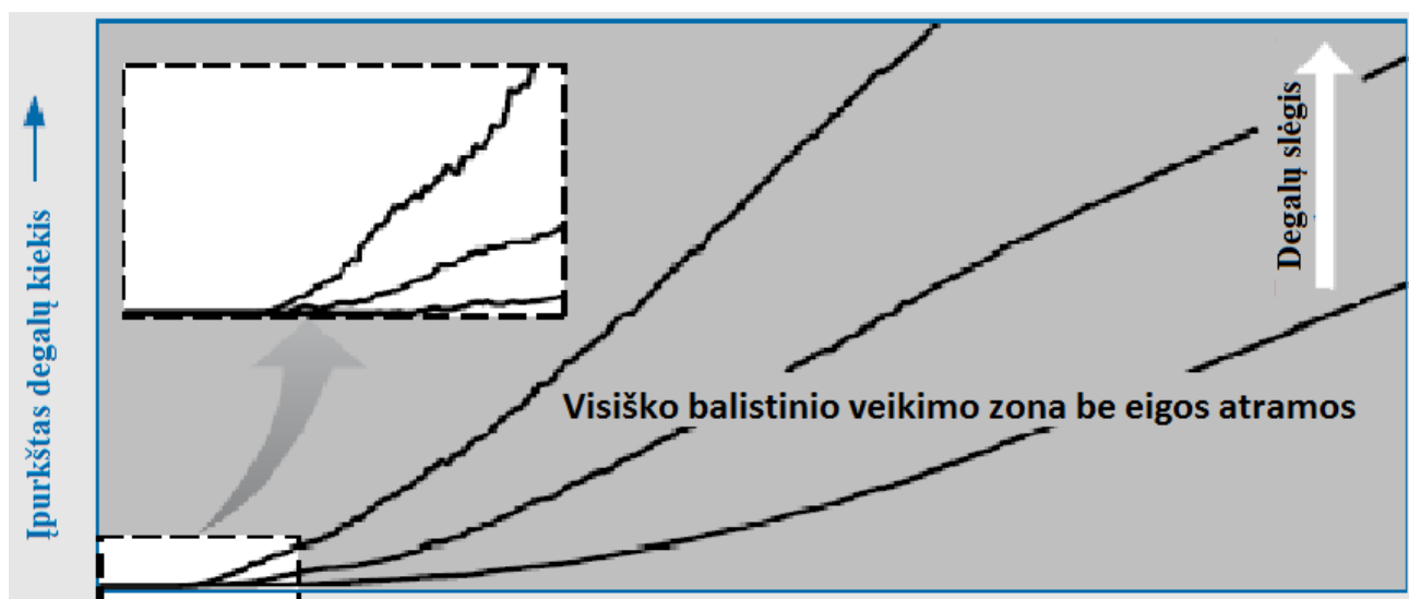
2.2.4 pav. Purkštovo be eigos atramos įpurškiamų degalų kiekio charakteristikos [5]
