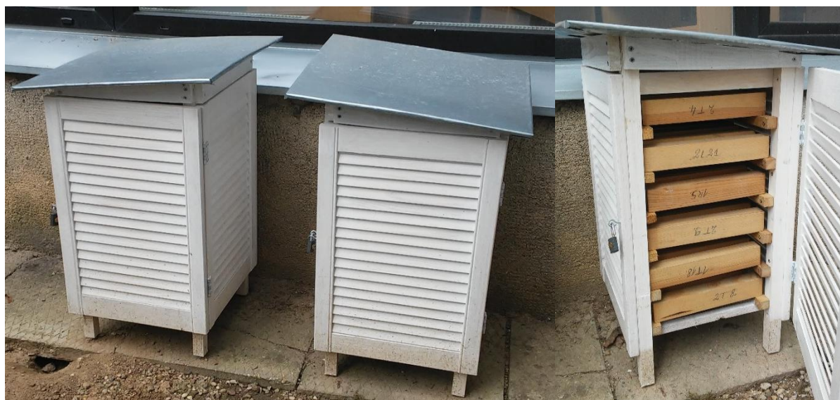
2.2 pav. Meteorologinės spintelės, kuriose laikomi bandiniai
