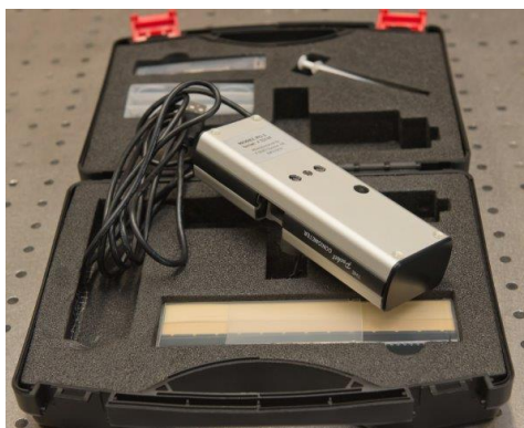
2.8 pav. Goniometras Pocket Goniometer PG-2 (Rycobel, Belgija)
