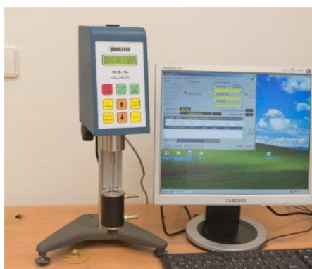
2.2 pav. Rotacinis viskozimetras „Brookfield DV II+Pro“ [68]
