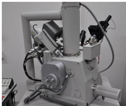
2.5 pav. Skenuojantis elektroninis mikroskopas (SEM) S-3400N (Hitachi) [73].
