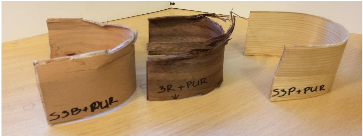
37 pav. Trijų lukšto sluoksnių bandiniai, klijuoti PUR klėjais
