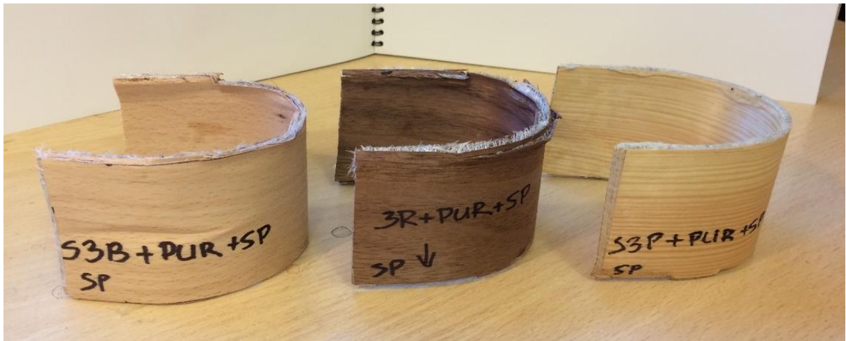
38 pav. Trijų lukšto sluoksnių bandiniai, klijuoti PUR klėjais ir įterptas stiklo pluoštas
