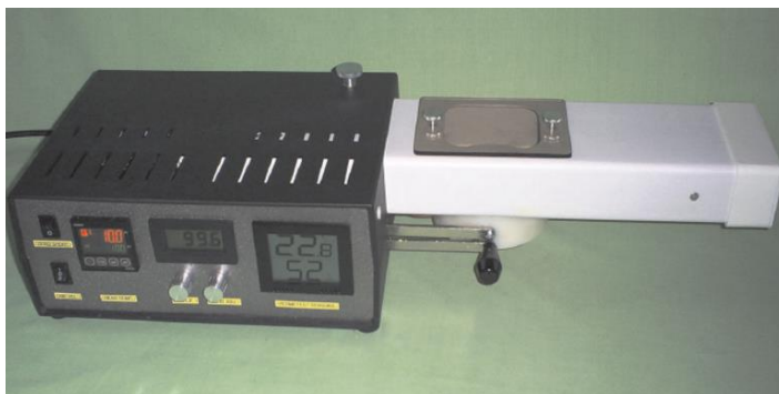
14 pav. Permetest – kompaktiškas „odos modelio“ tipo greitas testeris [26]
