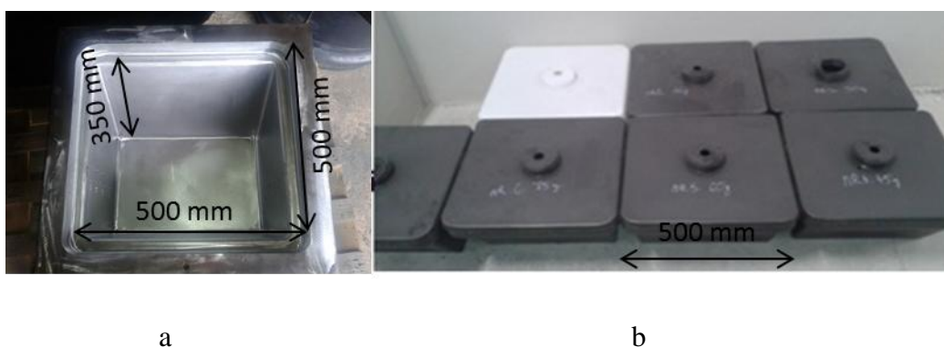
2.4 pav. Bandiniai tyrimams: a – bandinių forma; b – bandiniai su skirtingu juodųjų suodžių kiekiu
