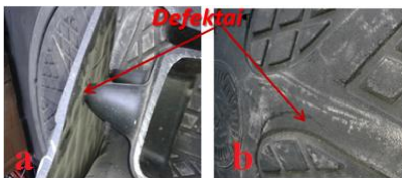
1.12 pav. Defektai gaminiuose, suformuotuose iš LLDPE kompozicijų su skirtingu juodųjų suodžių kiekiu: a – 2,5 %; b – 3,0 %
