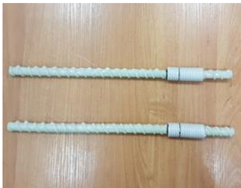
3.3 pav. Armatūros paruošimas: a – įbetonavimui paruošta armatūra; b – armatūros padėtis bandinyje
