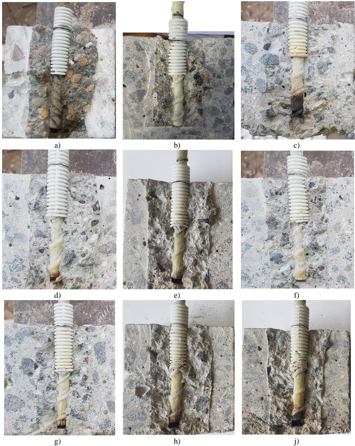
5.5 pav. Bandiniai po atsparumo ugniai ir armatūros ištraukimo bandymų: a – su plienine armatūra; b – kontrolinis temperatūros nepaveiktas; c – kontrolinis temperatūros paveiktas; d – su 0 % fosfogipso kiekio danga; e – su 1 % fosfogipso kiekio danga; f – su 3 % fosfogipso kiekio danga; g – su 5 % fosfogipso kiekio danga; h – su 7 % fosfogipso kiekio danga; j – su 10 % fosfogipso kiekio danga
