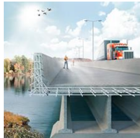
1.4 pav. Kompozitinės armatūros naudojimas tiltų statyboje („Schöck Bauteile GmbH“) [2]
