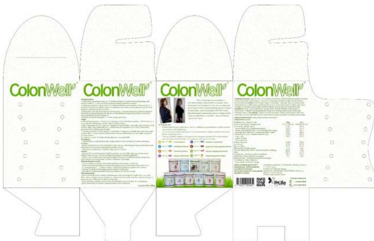
11 pav. Projektuojamos dėžutės išklotinė
