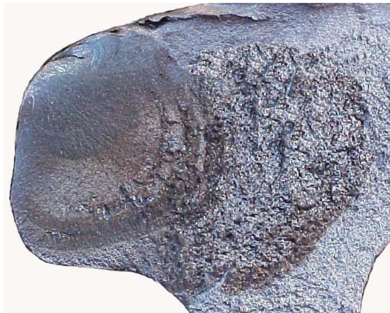
7 pav. Galvutės įtrūkimas [9]
