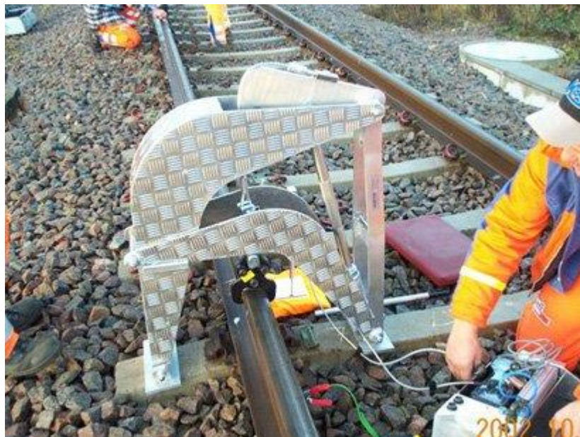
10 pav. Įtampių bėgiuose matavimo sistema VERSE [10]
