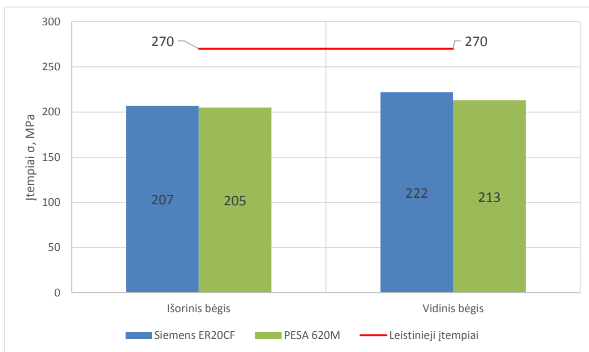
32 pav. 620 m spindulio kreivės rezultatai
