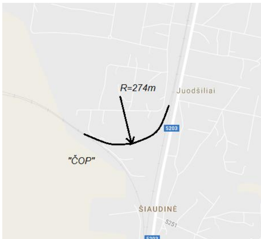
14 pav. 274 m spindulio kreivė, ruožas Vaidotai – Kirtimai
