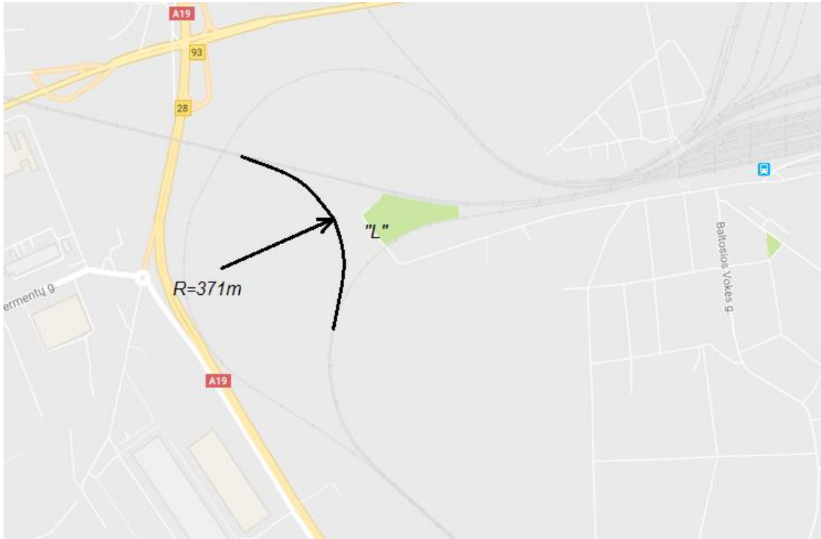
15 pav. 371 m spindulio kreivė, ruožas Vaidotai – Vokė
