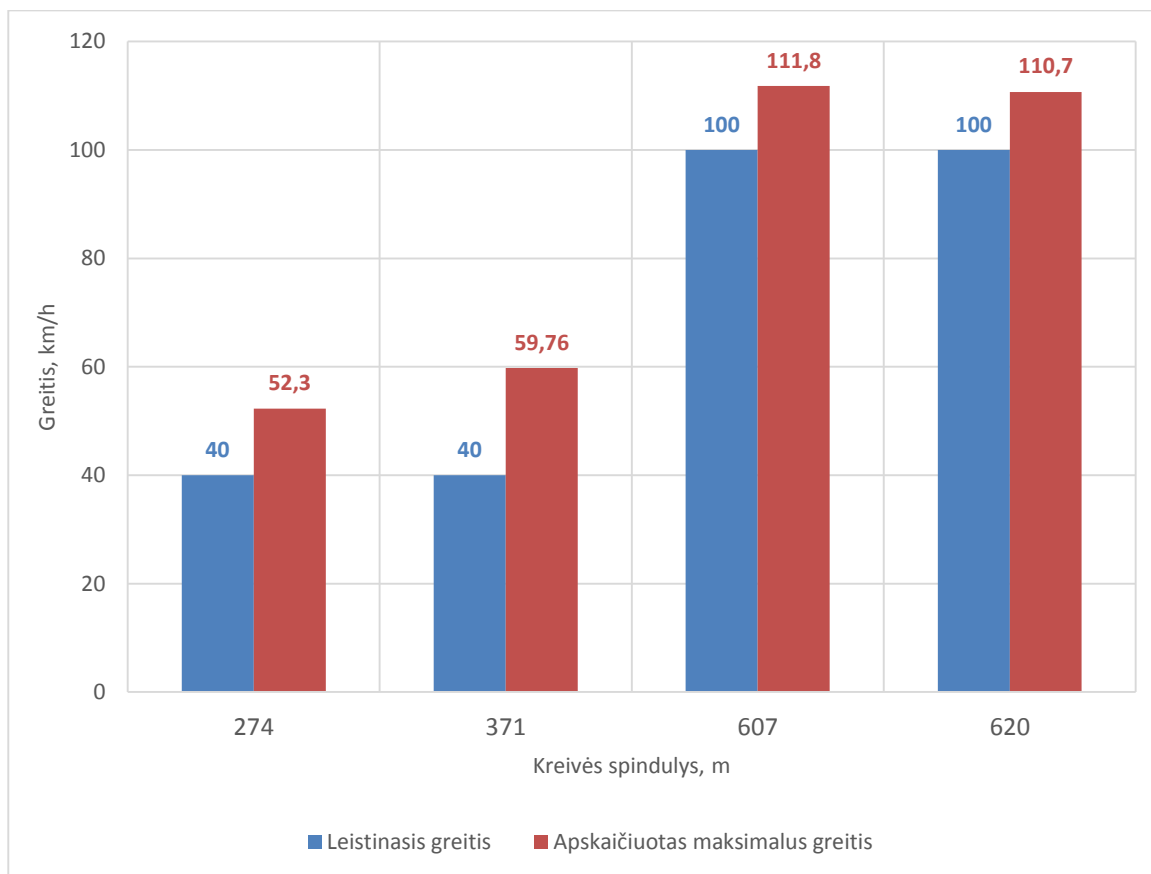
40 pav. Greičio priklausomybė nuo kreivės spindulio (automotrisė PESA 620M)
