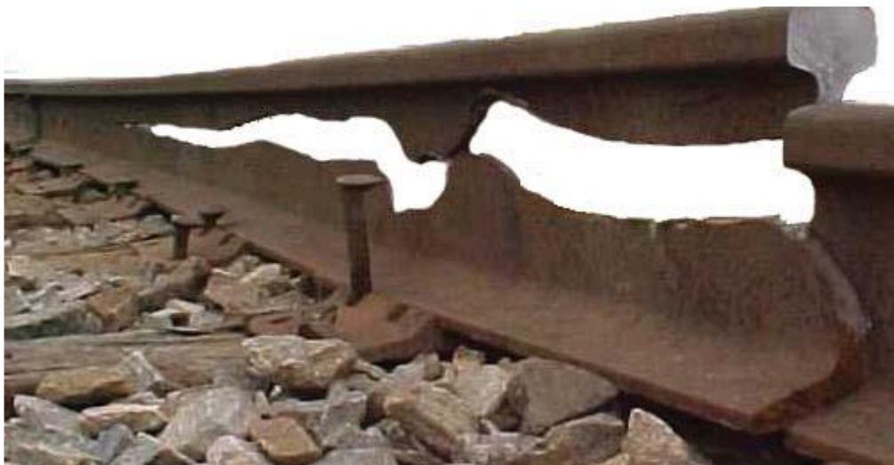
8 pav. Kakliuko atsiskyrimas nuo galvutės [9]
