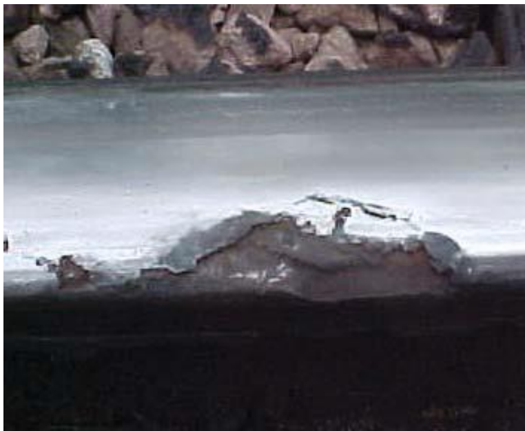
9 pav. Bėgio galvutės atsisluoksniavimas [9]
