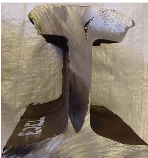
3 pav. Plastinių deformacijų atsiradimas vidiniame bėgyje [21]
