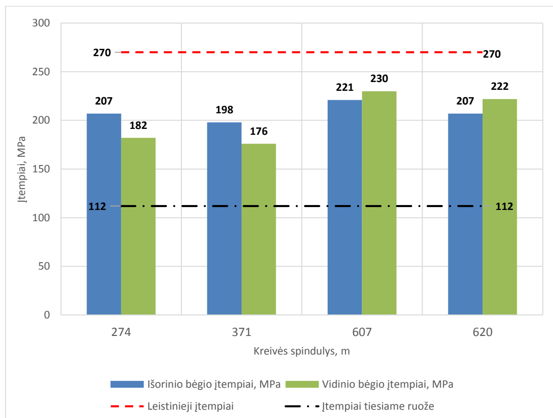
37 pav. Įtempių priklausomybė nuo kreivės spindulio (lokomotyvas Siemens ER20CF)
