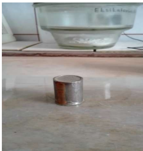
2 pav. Sutardo viskozimetras sklidumui nustatyti
