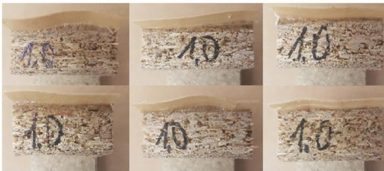
45 pav. Klevo medienos lukšto klijavimo defektai po 0 min. atviro išlaikymo trukmės.
