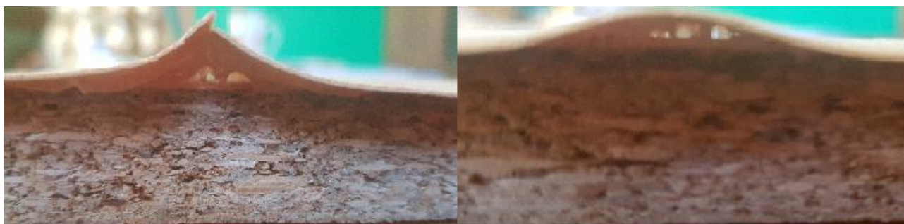
52 pav. PChP klijais klijuoto klevo lukšto defektai, po klijų plėvelės pakaitinimo pramoniniu fenu.
