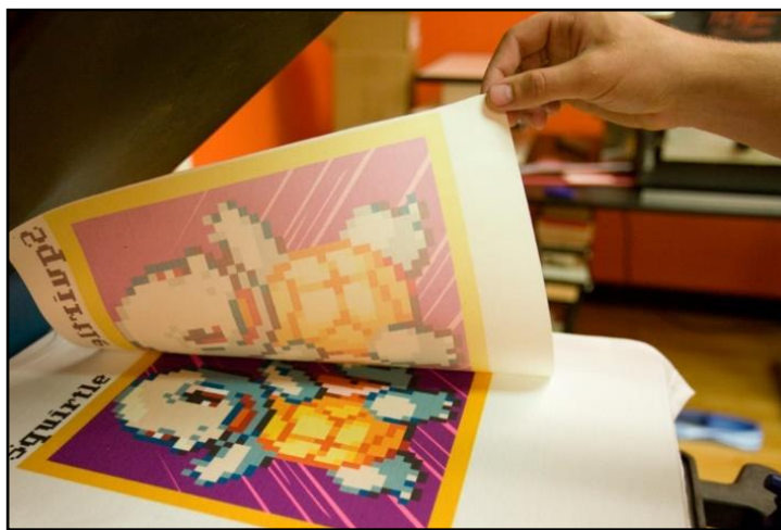
2.3 pav. Sublimacinės spaudos procesas, veidrodinis atvaizdas
