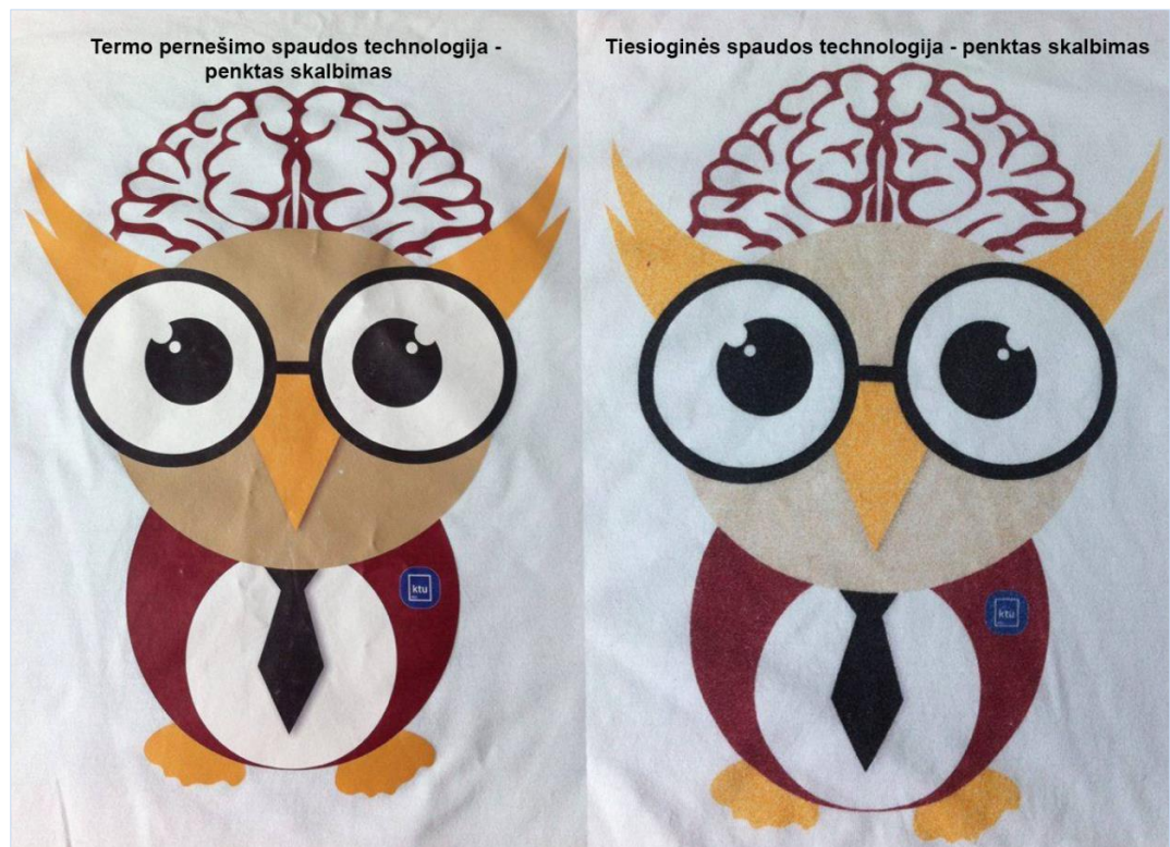
2.24 pav. Termo pernešimo spaudos (vaizdas iš kairės) ir tiesioginės spaudos (vaizdas iš dešinės) 30° C temperatūra (penktas skalbimas)
