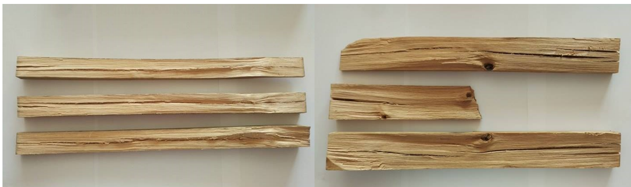
3.15 pav. Džiovinimo metu, medienos vidinėje struktūroje susiformavę įtrūkimai
