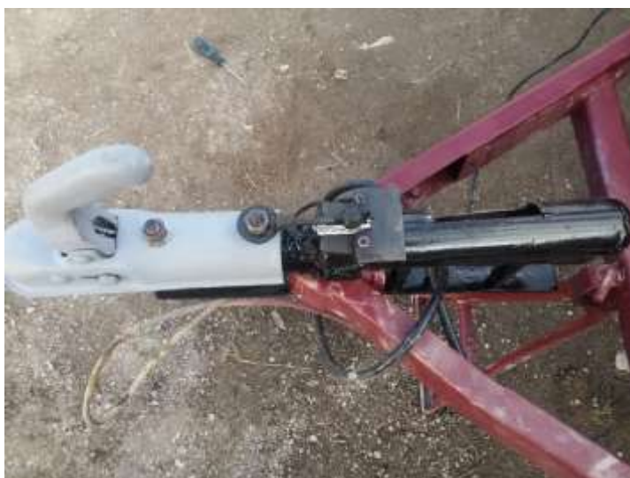
2.7.5 pav. Pagamintas sukabinimo įtaisas sumontuotas ant priekabos gražulo
