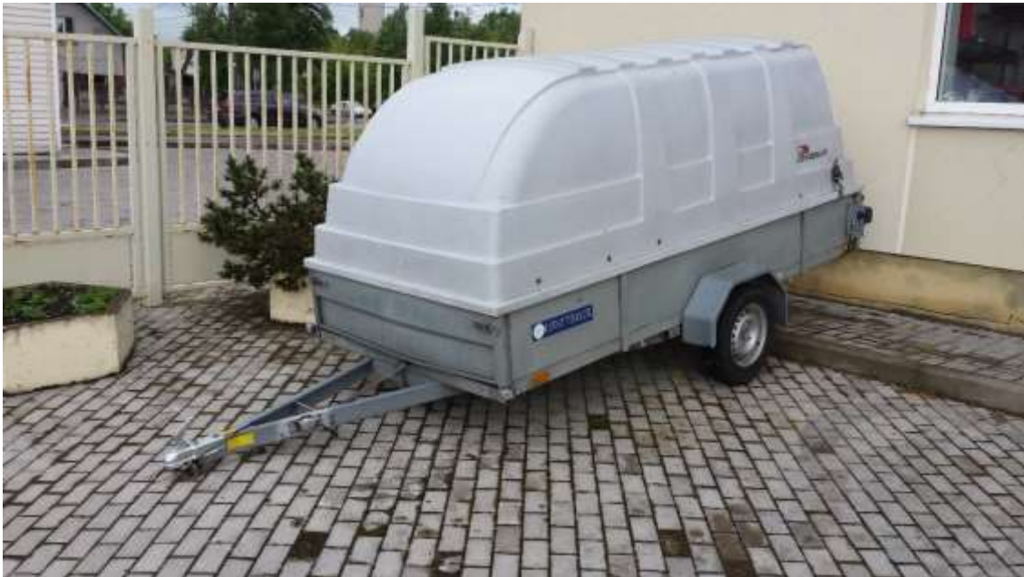
1.2.1 pav. Aerodinamiškesnė automobilinė priekaba, kuri primena lašo forma[10]
