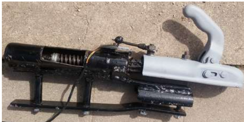
2.7.4 pav. Pagamintas sukabinimo įtaisas
