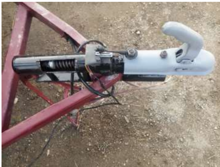
2.7.6 pav. Pagamintas sukabinimo įtaisas sumontuotas ant priekabos gražulo
