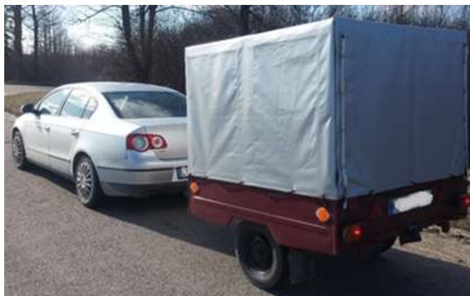
3.3.1 pav. Bandymas su priekaba aukštu tentu, automobiliu Volkswagen Passat
