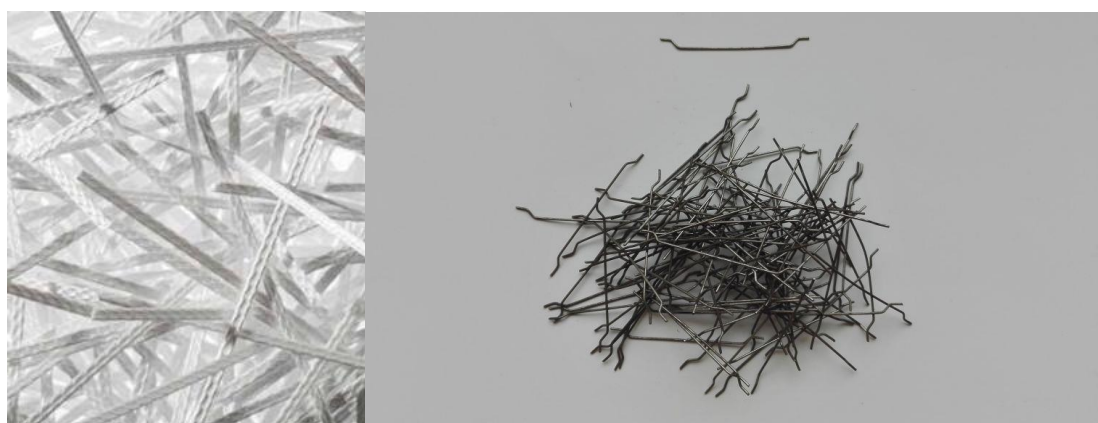
2.2 pav. Polipropileno plaušas (kairėje) ir plieno plaušas lenkais galais (dešinėje)
