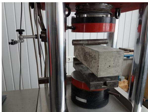
2.7 pav. Tritaškio lenkimo bandymo schema nustatant betono tempiamąjį stiprį (kairėje) ir bandymo vaizdas (dešinėje)
