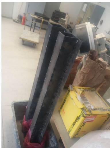
4.8 pav. Sijos prieš betonavimą
