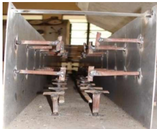
1.16 pav. Arvind, M. ir kt. [7] kompozitinės sijos plieninis profilis
