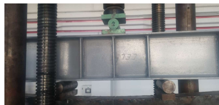
4.5 pav. Apkrovų perdavimo plokštelės, cilindrai ir traversa
