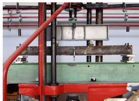
4.7 pav. Hidraulinis presas GRM-1 ir sija, paruošta lenkimo bandymui
