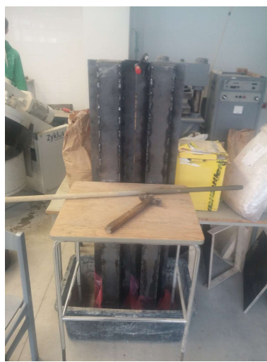
4.9 pav. Sijos po betonavimo
