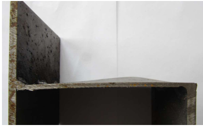
P.13 pav. Išklupusi HSQ sijos sienutė
