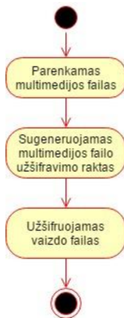
12 pav. Multimedijos failo užšifravimo schema
