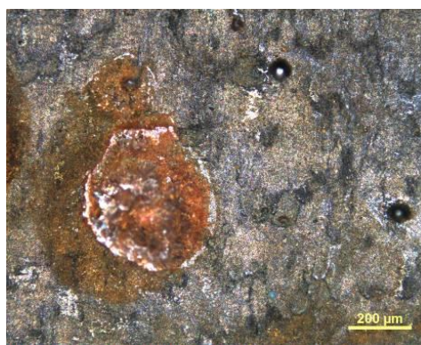
1.2 b pav. Cor-Ten plieno paviršiaus vaizdas po cikliško temperatūrų svyravimo 3% NaCl tirpalo aplinkoje (1 bandinys, apatinė pusė)
