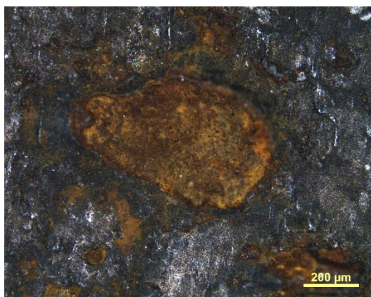
1.2 c pav. Cor-Ten plieno paviršiaus vaizdas po cikliško temperatūrų svyravimo 3% NaCl tirpalo aplinkoje (2 bandinys, viršutinė pusė)
