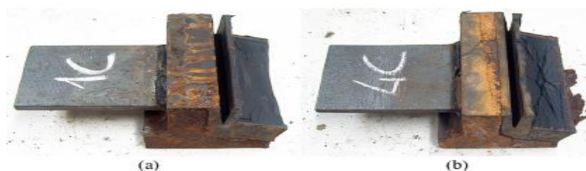
1.7.6. pav. Bandinių pavyzdžiai, kaip Cor-Ten plienas paveiktas korozijos [5]
