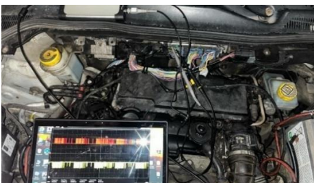
5 pav. Variklio valdymo bloko CAN signalų patikra
