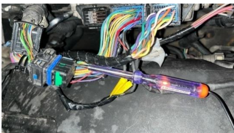
4 pav. EDC16C34 maitinimo kontaktų tikrinimas testavimo lempute
