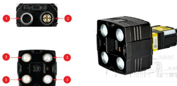
7 pav. Cognex In-Sight 2802 : 1,2 – išsišakojimo kabelio ir, atitinkamai, Ethernet jungtis, 3 – LED apšvietimas [18]
