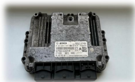
9 pav. Variklio valdymo blokas EDC16C34 Šaltinis: nuotrauka autorių
